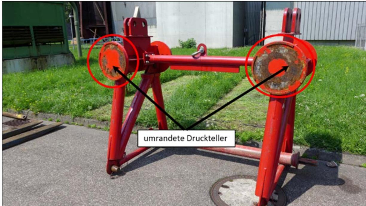
Abbildung 18: Geänderte Kurzkupplung
