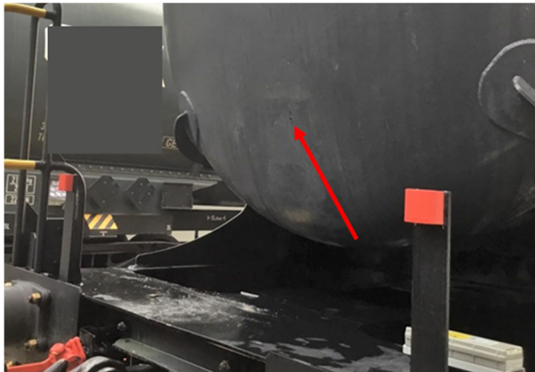
Abbildung 3: Position des Lochs ca. 605 mm über der Wagenplattform.
