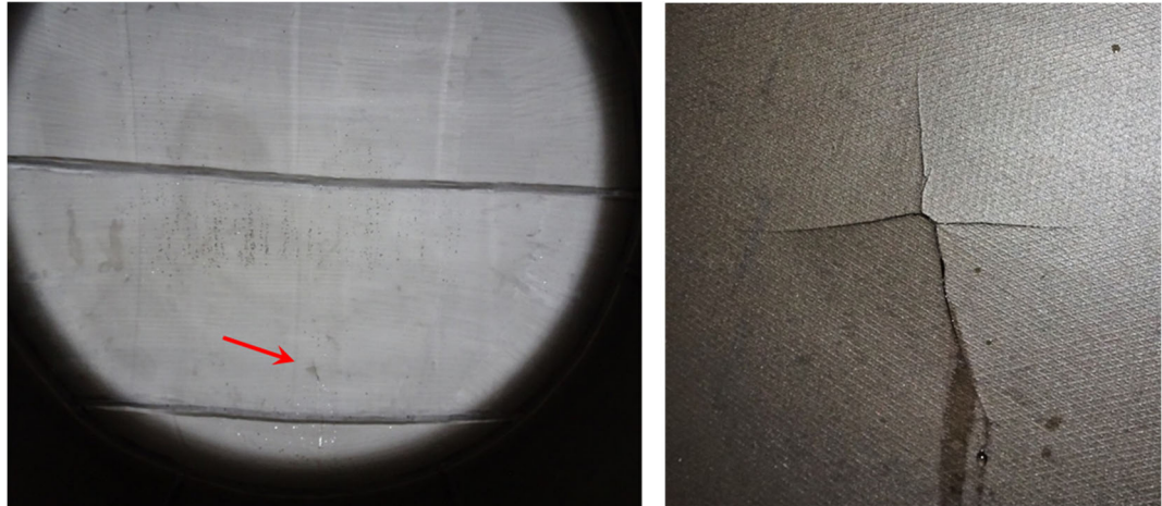
Abbildung 5: Linkes Bild: Situation im Tankinnern (Pfeil zeigt auf Bruchstelle). Rechtes Bild: Detailaufnahme der kreuzförmigen Bruchstelle in der Schutzschicht.
