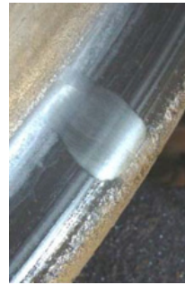
Abbildung 29: Schmierfilm an der Spurkranzflanke
