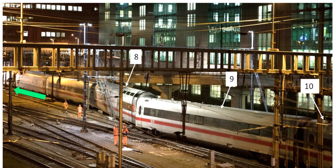
Abbildung 4: Endlage des Zuges nach der Entgleisung. Grüner Pfeil: Fahrtrichtung nach Gleis 5. Entgleiste Wagen Nr. 8 bis 10.
