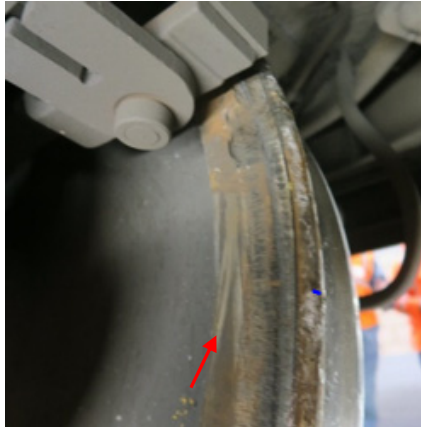
Abbildung 20: Achse1, Rad links; Abrutschspur auf der inneren Seite des Rades, herrührend davon, als das Rad zwischen Stockschiene und Weichenzunge RL wieder abgerutscht ist.
