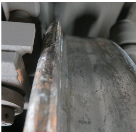
Abbildung 19: Achse 1, Rad Links, scharfkantige Spurkranzkuppe, qR-Mass 7.38 mm (zuerst entgleistes Rad).
