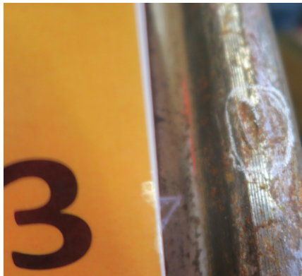
Abbildung 21: Achse 2, Rad links; Spurkranz mit Anschlagspur (hinterlassen von der Spitze der Weichenzunge RL)
