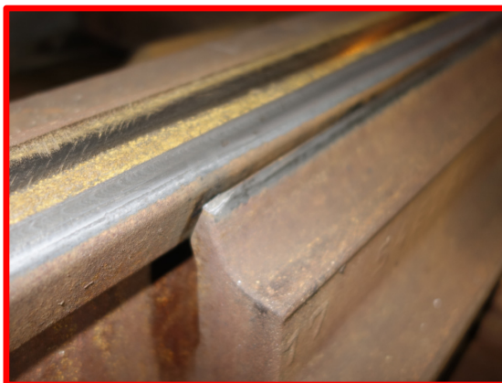
Abbildung 11: Spitze der Weichenzunge RL mit kleiner Schlagspur. Der Schienenkopf der Stockschiene und die Weichenzunge wiesen keinen Schmierfilm auf.
