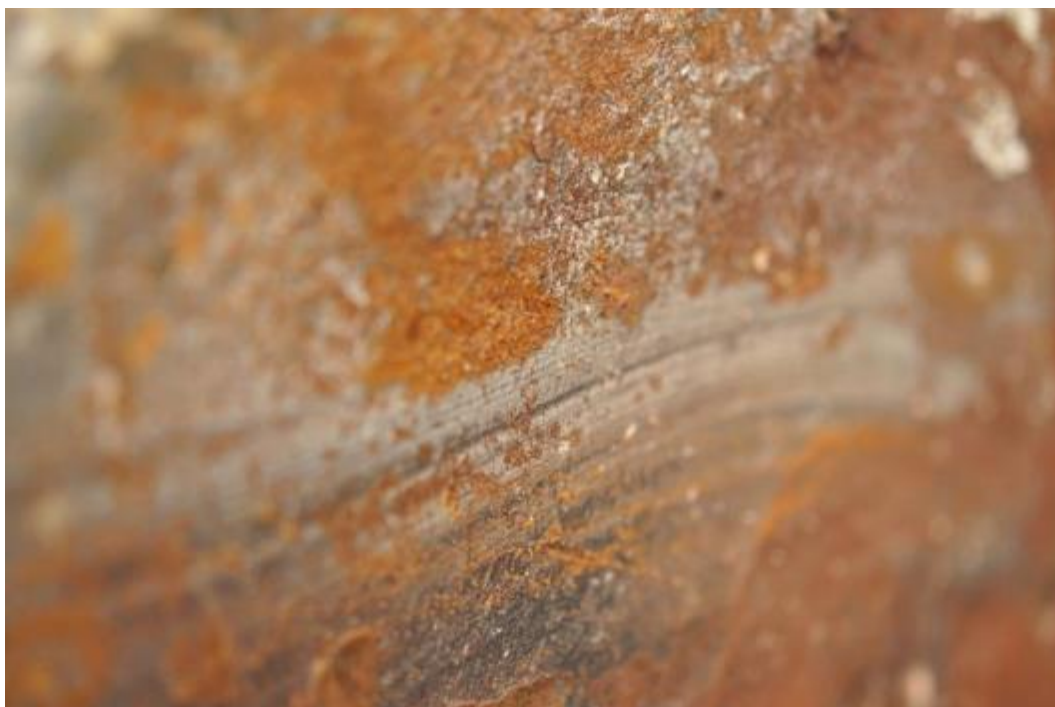
Figuur 46 : Detail van breukoppervlak aan kant B
