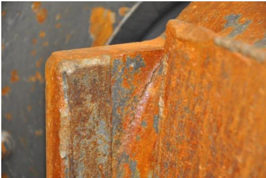
Figuur 57 : Barst aan de basis van de zijvlak van de wielasbus van wiel B
