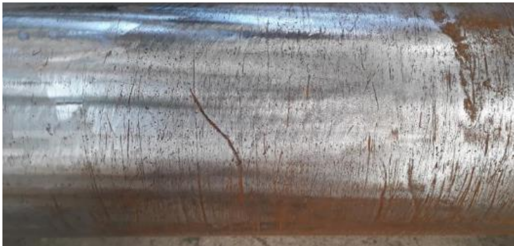
Figuur 76 : Uitzicht van wielas na schuren, middendeel
