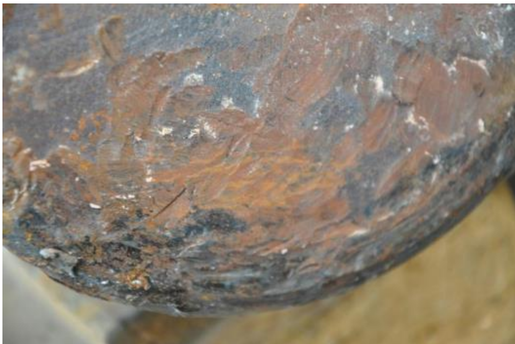
Figuur 35 : Breukoppervlak van kant B
