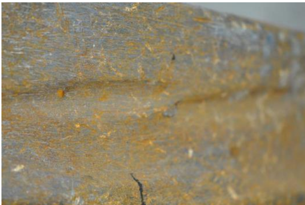
Figuur 14 : 2 merken van indrukking op de loopvlak van wiel A
