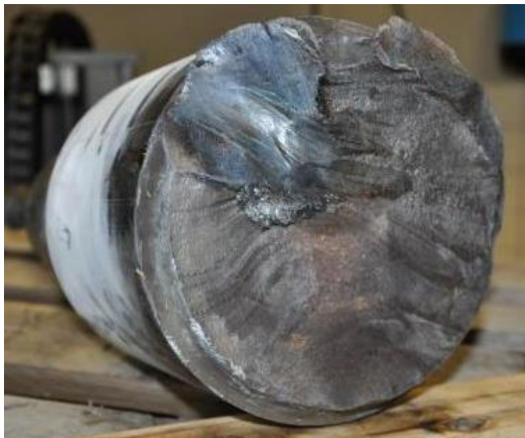
Figuur 91 : Breukoppervlak van wielas A na magnetisch onderzoek
