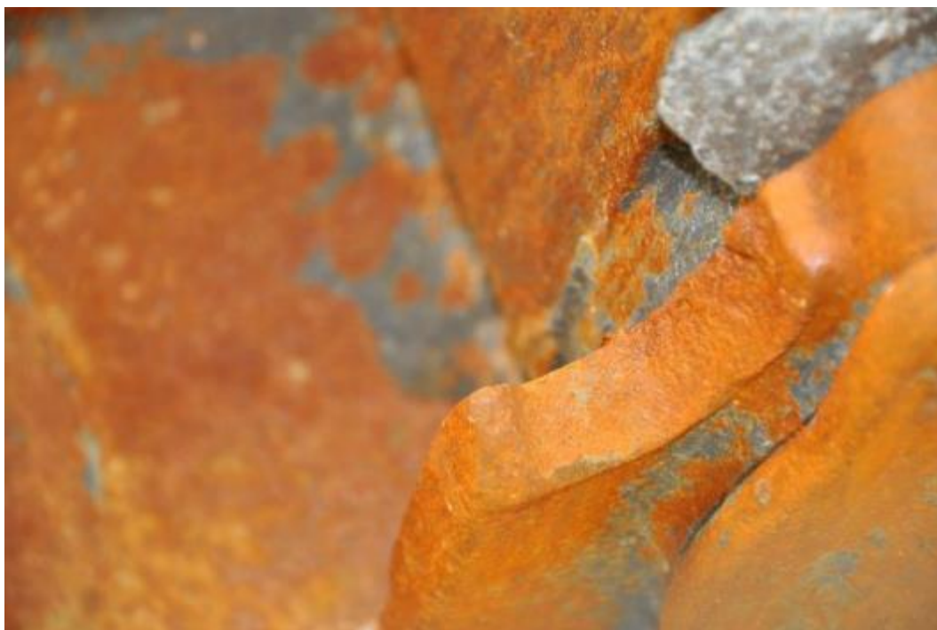
Figuur 56 : Gebroken stuk op de wielasbus van wiel B
