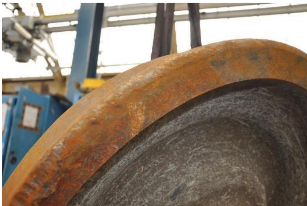
Figuur 19 : Binnendeel van de kraag van wiel A met groeven
