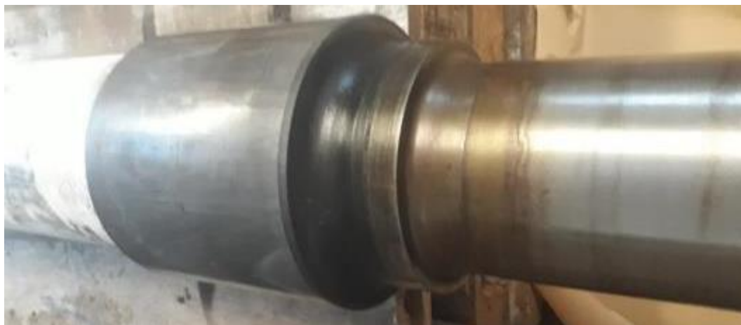
Figuur 87 : Uitzicht van astap en wielnaafzitting van wielas B na demontage
