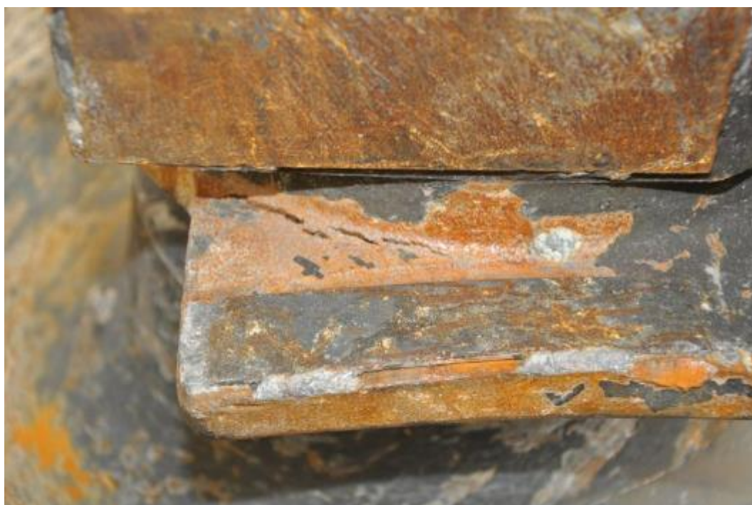
Figuur 20 : Barsten in de wielasbus van de wiel A
