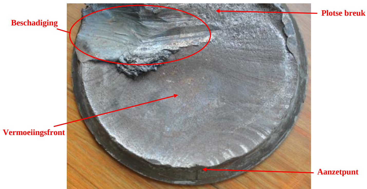
Figuur 100 : Generale uitzicht van breukoppervlak A
