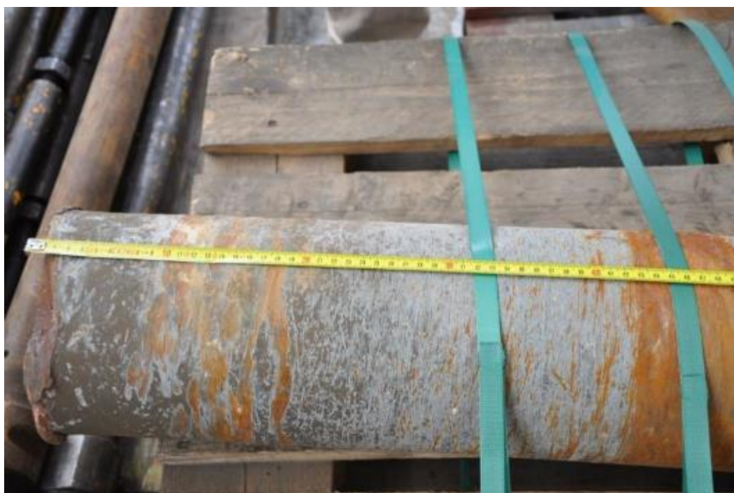
Figuur 62 : Deel van de wielas aan de kant van breukoppervlak B
