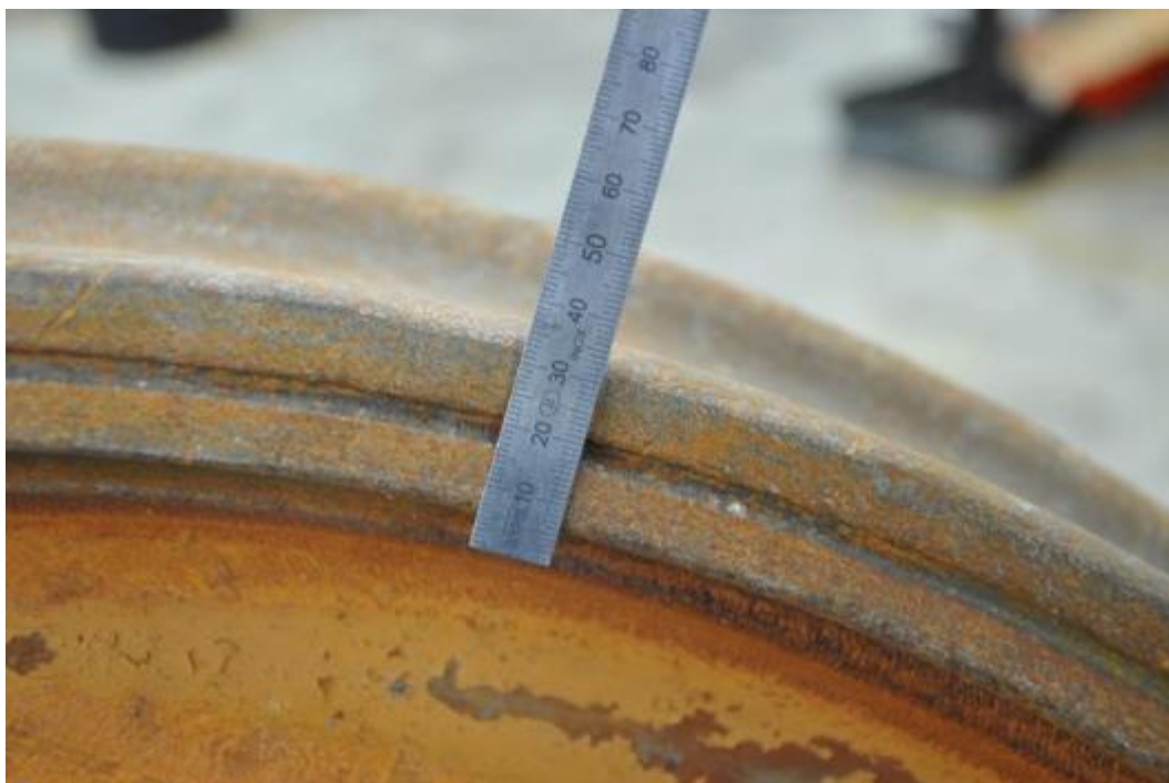
Figuur 24 : Sleetgroef van de wiel A, buitenkant van wiel
