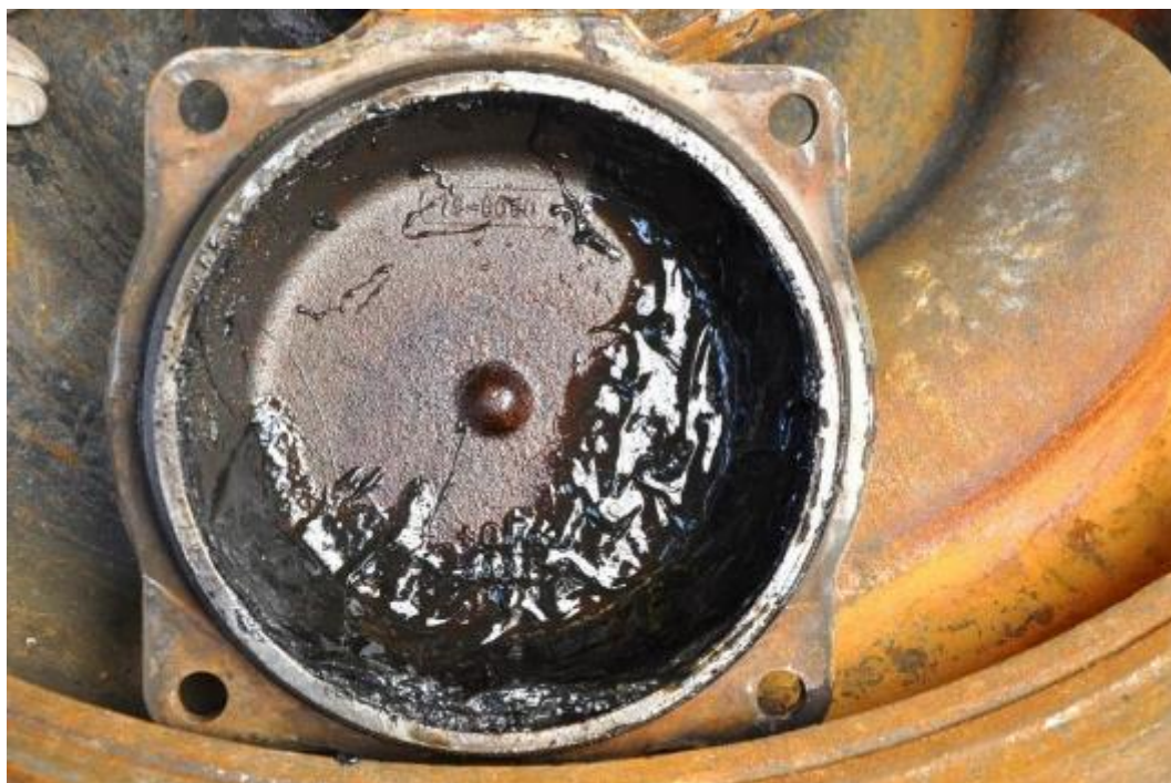
Figuur 28 : Uitzicht van binnendeel van deksel van wielasbus A
