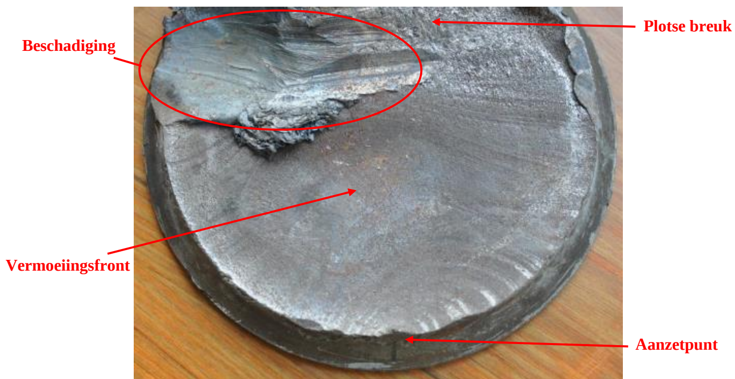
Figuur 100 : Generale uitzicht van breukoppervlak A
