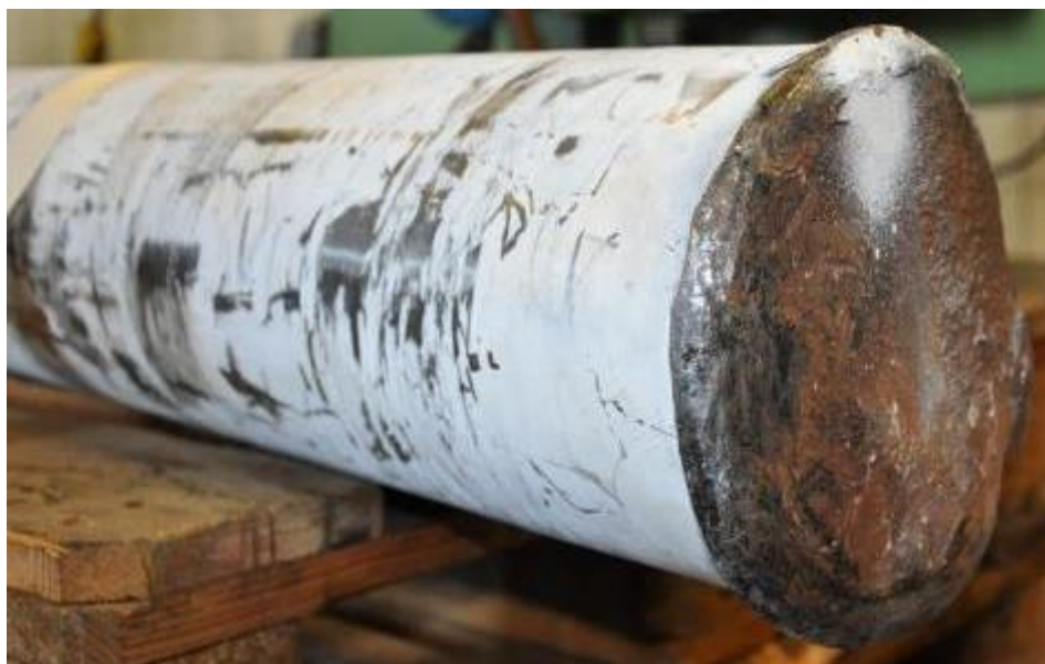
Figuur 97 : Uitzicht van breukoppervlak B van wielas
