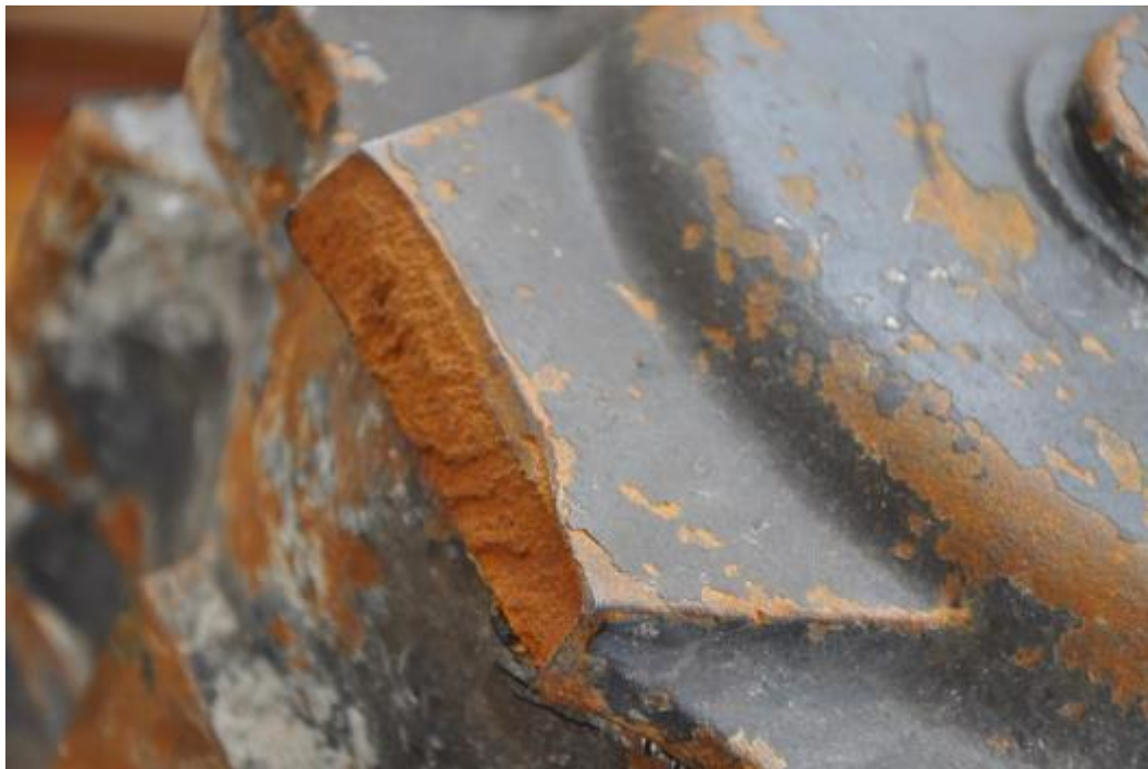
Figuur 21 : Gebroken stuka an de wielasbus van wiel A
