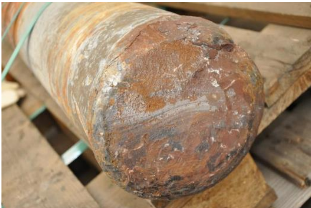
Figuur 33 : Breukoppervlak van kant B
