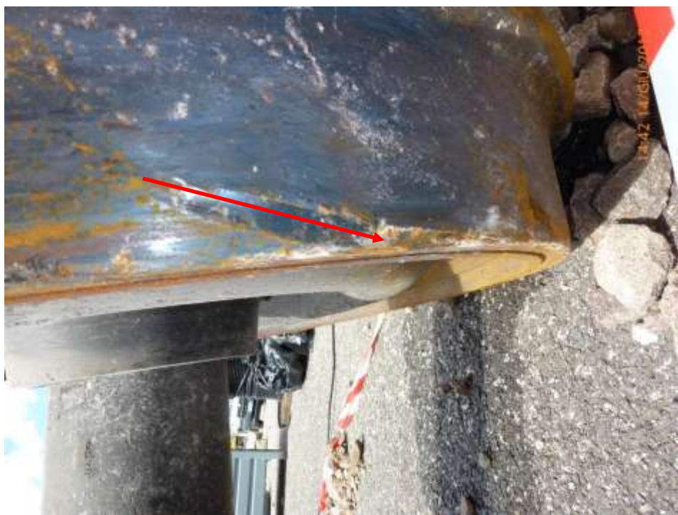
Figura 26 – sala B lato B (segno sulla ruota DX del IV assile)
