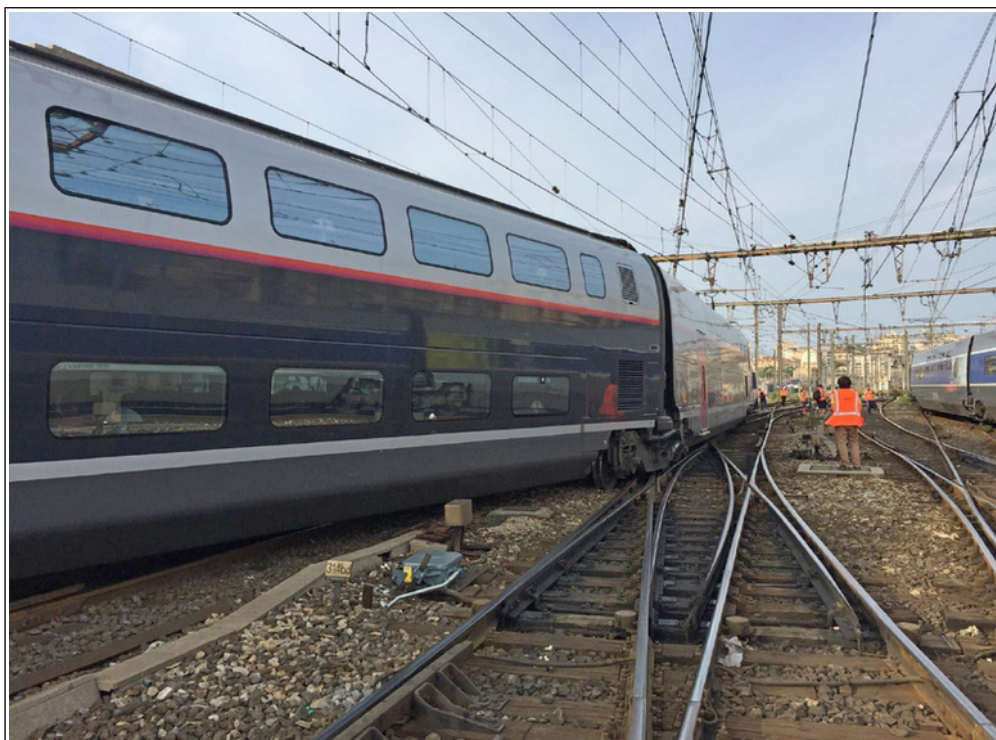
Figure 1 : la rame déraillée en entrée de gare
