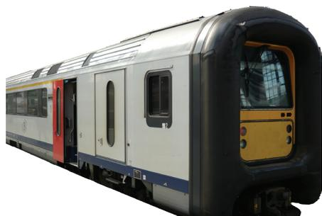
Le train E922 était composé d'une seule automotrice AM454 de type AM96, composée de 3 voitures.
