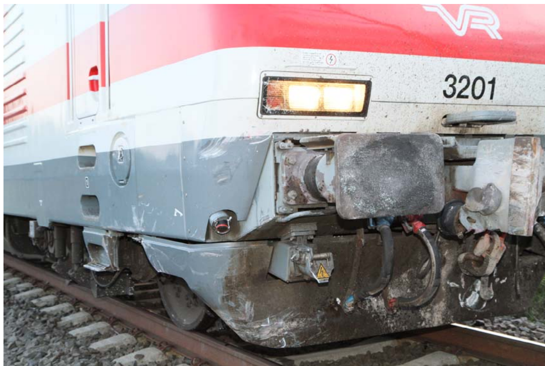
Kuva 2. Veturi vaurioitui lähinnä oikeasta etukulmastaan. (kuva poliisi)
