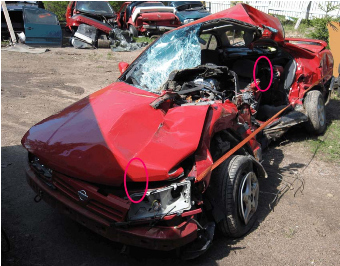
Kuva 3. Henkilöauto romuttui korjauskelvottomaksi. Veturin puskimien osumakohdat merkitty punaisilla ympyröillä.
