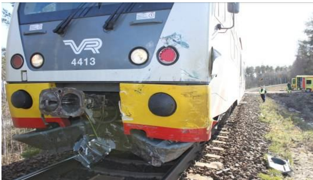
Kuva 3. Taajamajunan keula vaurioitui onnettomuudessa.
