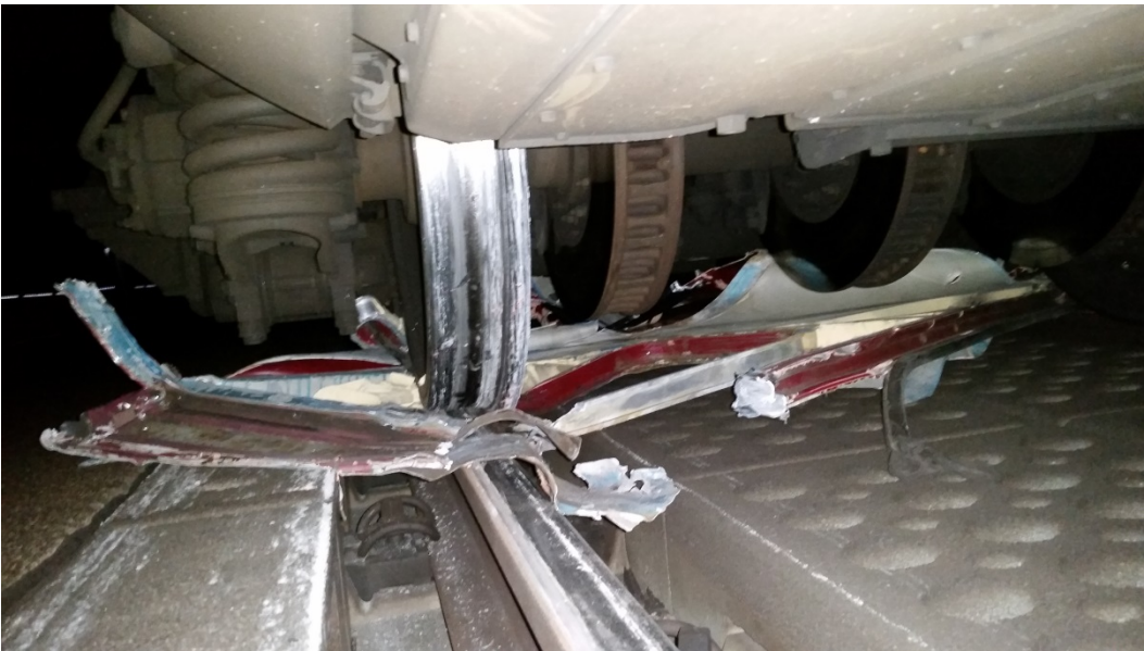
Abbildung 20: Seiteneinstiegstür unter dem dritten Radsatz des Z 90 (Quelle RU)
