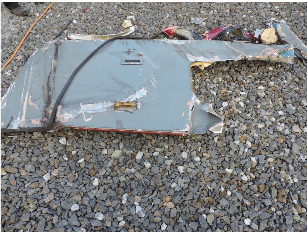
Abbildung 22: Sichergestellte Teile der Seiteneinstiegstür (Quelle IM)
