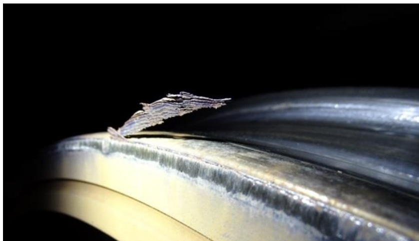
7. ábra: súrolásnyom és sorja a 624-1 kocsi jobb oldali, harmadik kerekén
