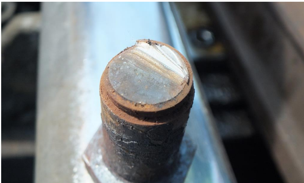
7. ábra: a csavar fáradásos törési felülete
