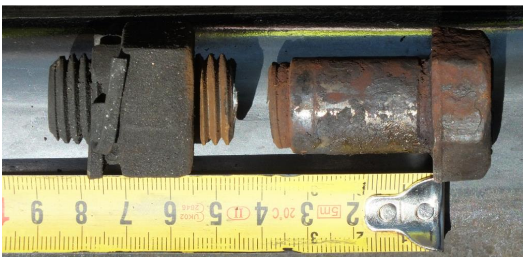
6. ábra: a törött csavar darabjai
