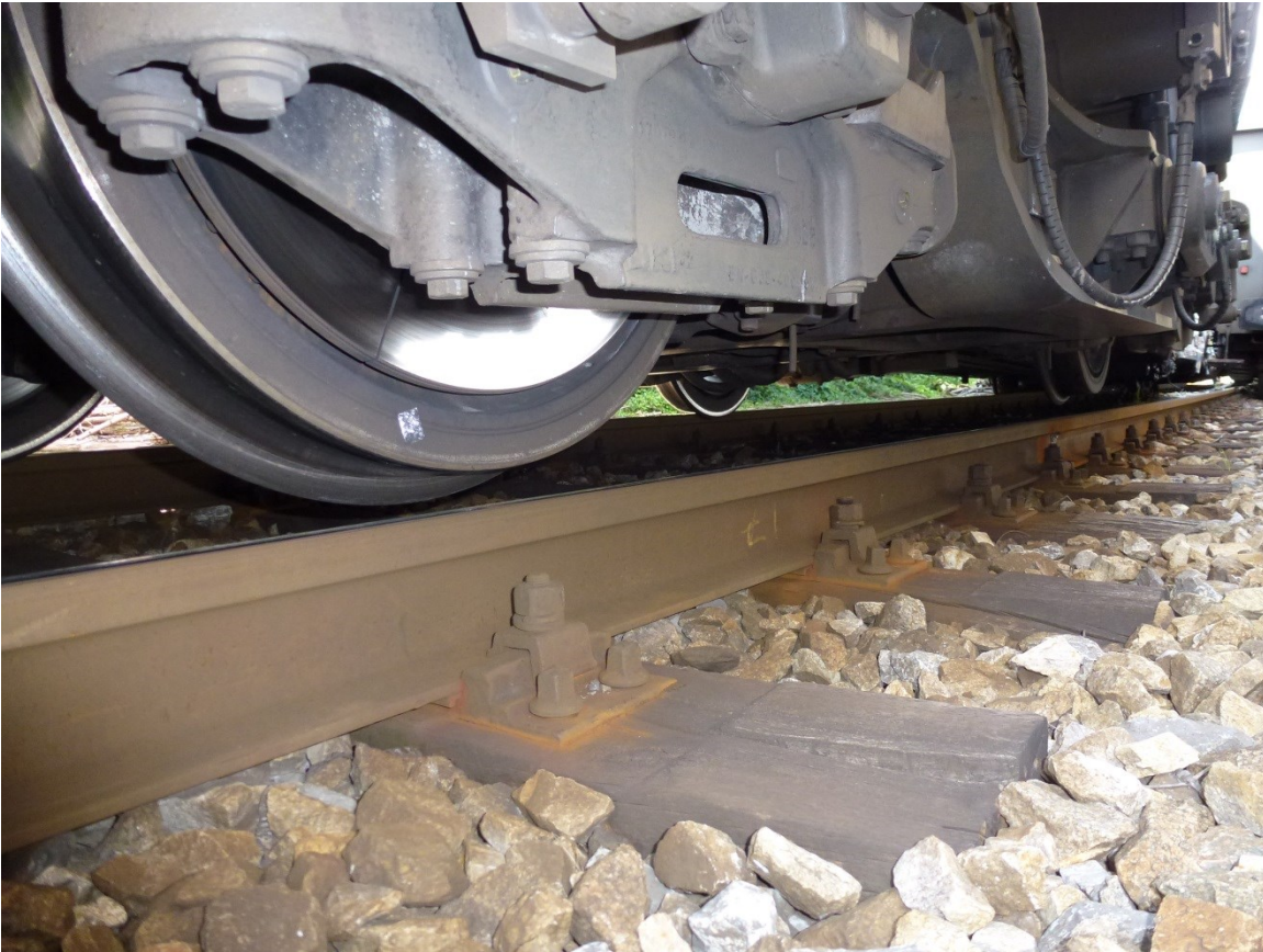
Abbildung 11: Entgleistes drittes Drehgestell Triebzug 4124 024-3 (Quelle SUB)
