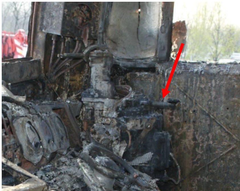
6. ábra A D12 fékezőszelep "gyorsfék" állása
