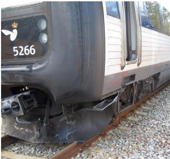
4 Nogle af skaderne på togsættets front
