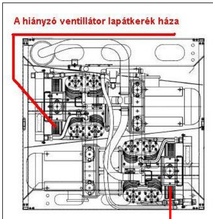
6. ábra A sűrített levegő előállító egység 1
