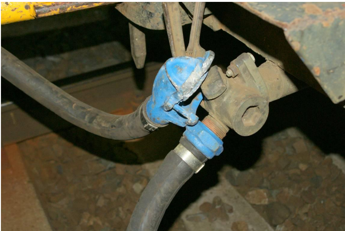
9. ábra: A lógó fővezeték tömlőn ütésnyomok
