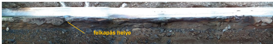
ábra: a kisiklást okozó domborulatn nincsenek oldalsó kopásnyomok
