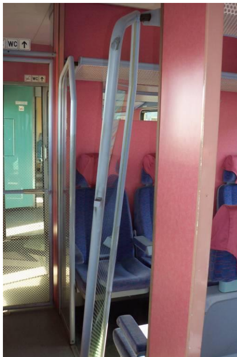
4. ábra Az ütközés következtében rongálódott utastér
