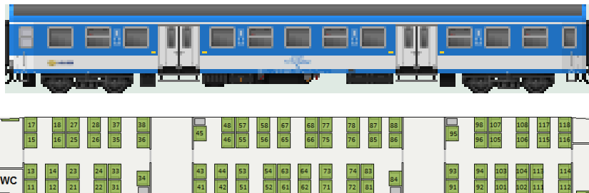
3. ábra A 21-55 sorozatú kocsi jellegrajza és belső elrendezése (forrás: vonatosszeallitas.hu)
