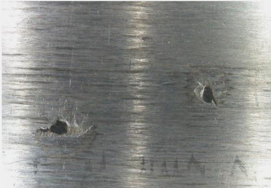
Bild 11: Eindruckstelle von Fremdpartikeln
