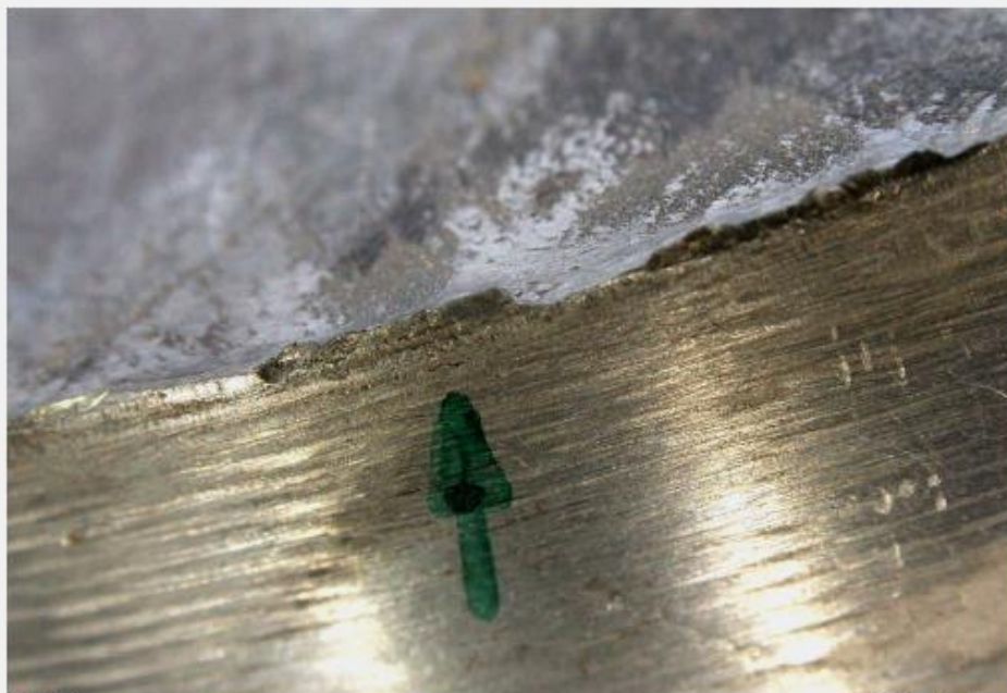
Bild 6: V = 7 : 1 weitere aufgeraute Stelle neben dem Rissausgang, hier ist deutlich ein Nebenriss zu erkennen (siehe linker Pfeil in Bild 5)
