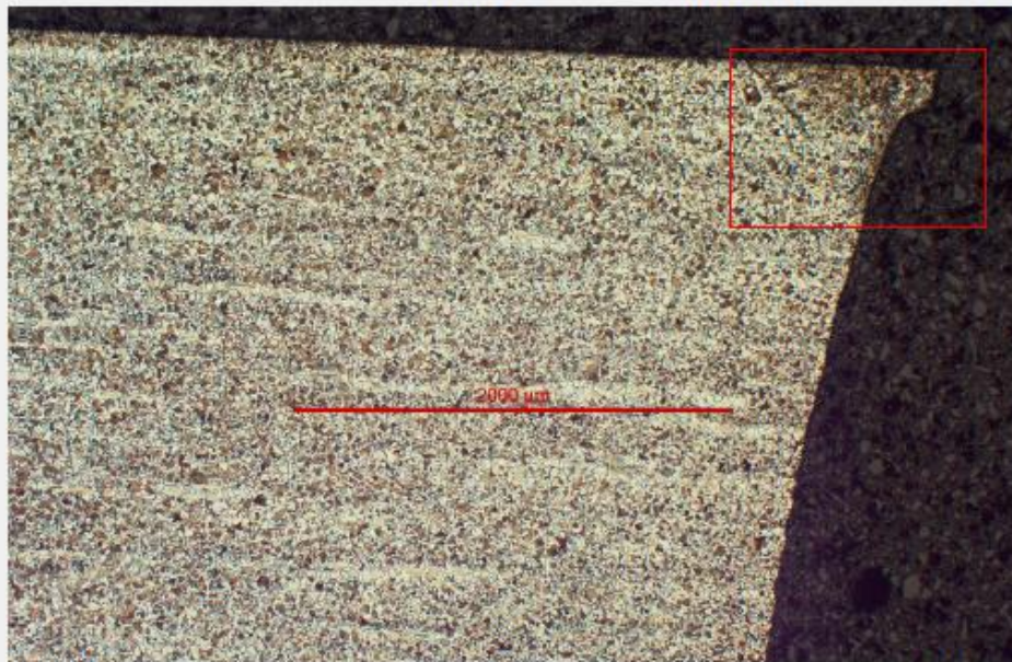
Bild 27: V = 34 : 1 Probe 2; Schliff durch den Bruchausgang, rechts Bruchfläche, ferritisch-perlitisches Werkstoffgefüge
