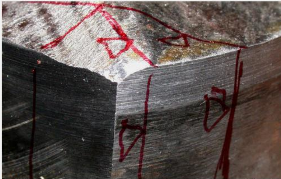
Bild 26: V = 6 : 1 Probenentnahme der Schliffe 7 und 8 (Probe 8 - Schrägschliff rechts im Bild), Bereich seitlich des Bruchausgangs, wo die eingearbeitete Entlastungsmulde noch am Rand des Bruches vorhanden ist
