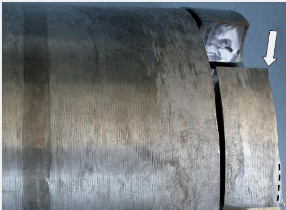
Bild 8: Lagersitzoberfläche in der Nähe des Rissausgangs (siehe Pfeil); die strichlierte Linie rechts markiert den Beginn der Entlastungsmulde
