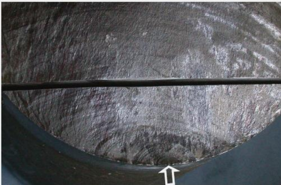
Bild 2: Bruchfläche nach dem Trennen und der Reinigung; Schwingbruch mit deutlichen Rastlinien und lokalem, beinahe punktförmigem Rissausgang (siehe Pfeil)
