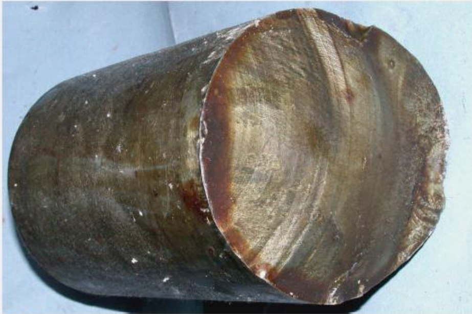
Bild 1: Wellenstummel im ungereinigten Anlieferungszustand, versiegelt mit Tectyl
