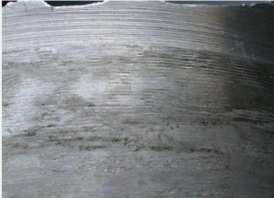
Bild 9: Oberfläche des Lagersitzes mit angrenzender Entlastungsmulde (oben), die an ihren gleichmäßigen Schleifriefen zu erkennen ist
