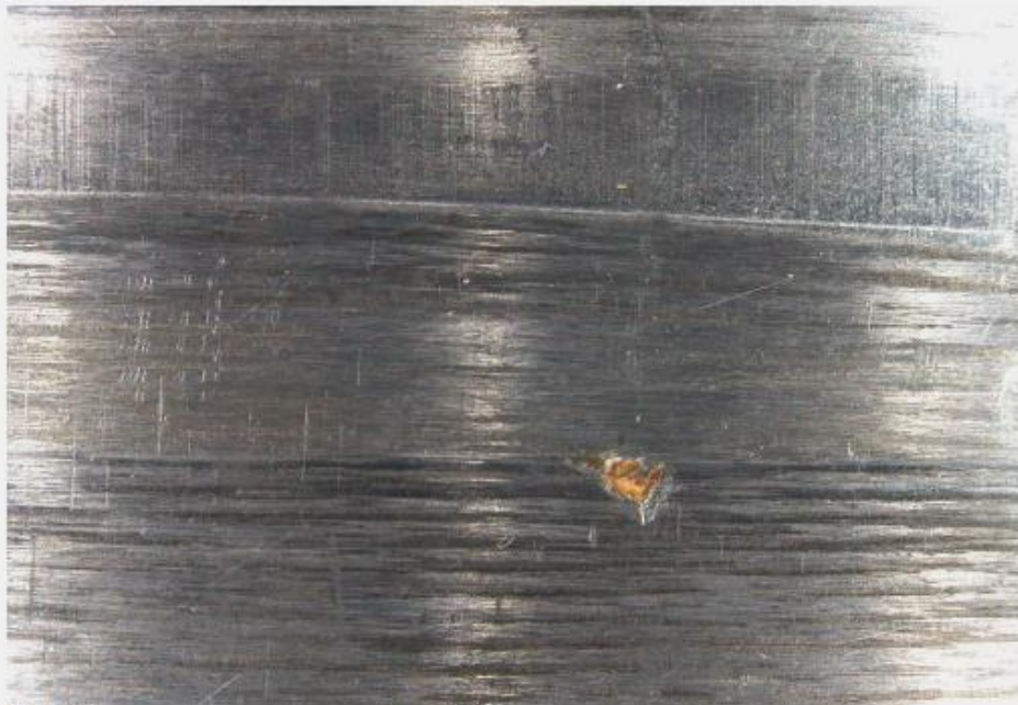
Bild 12: weitere Eindruckstelle von Fremdpartikeln
