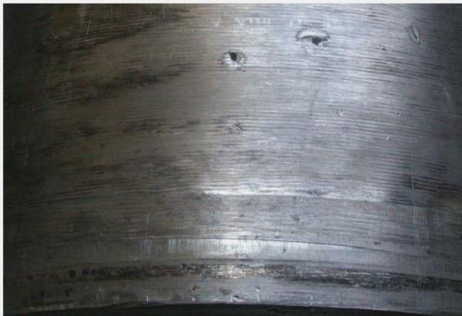
Bild 10: Lagersitzoberfläche an der Außenseite (Wellenende) mit eingepressten Fremdstoffen
