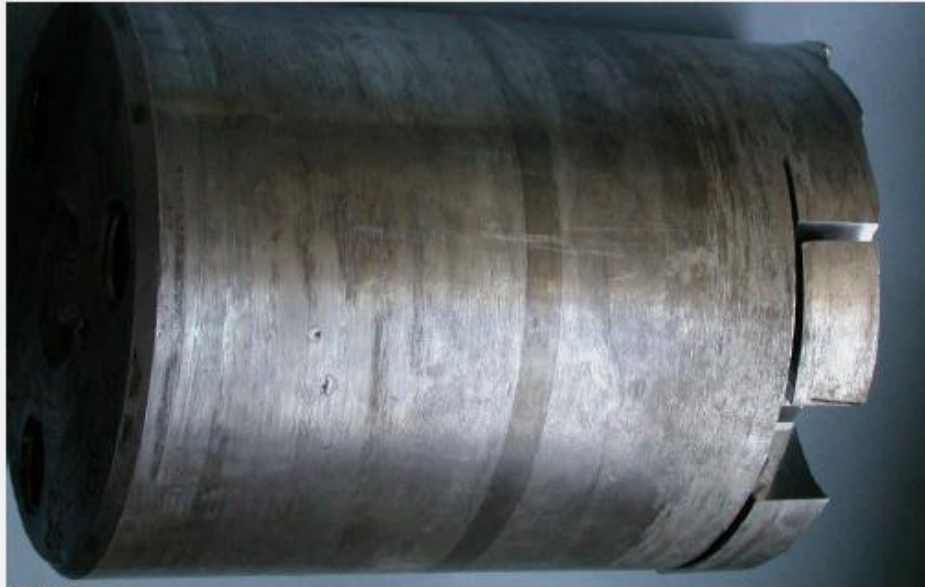
Bild 7: Oberfläche nach Entfernung der Tectylschicht; rechts bereits abgetrennter Rissausgangsbereich
