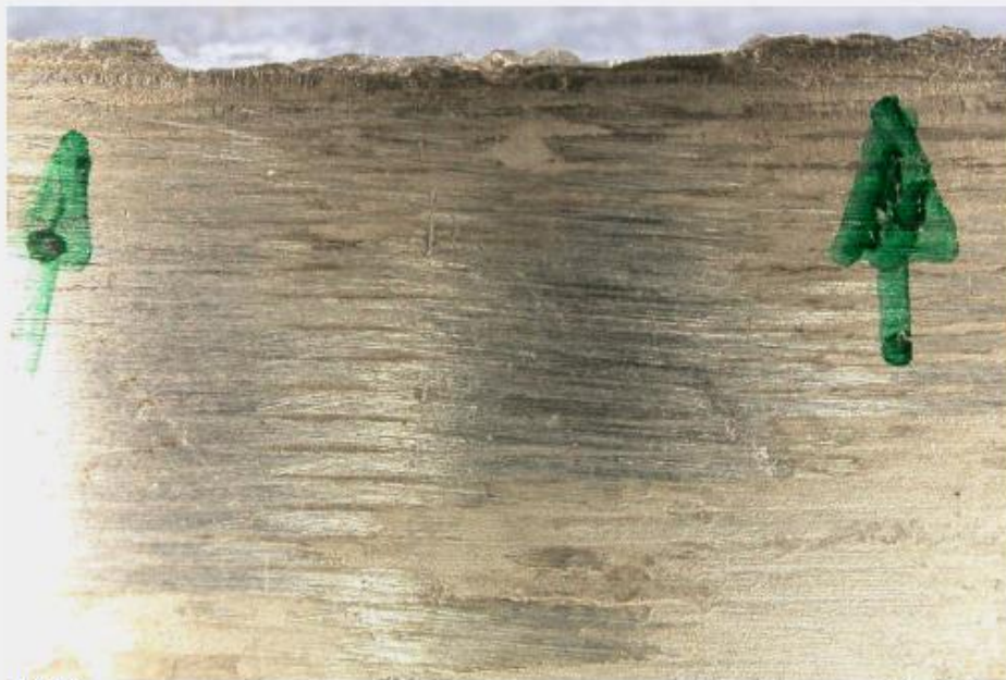
Bild 4: V = 7 : 1 Detail des Rissausgangsbereiches; die grünen Pfeile markieren Fehlstellen in der Wellenoberfläche; die angrenzende Wellenoberfläche lässt nur noch Reste von Drehriefen erkennen; unterschiedliche Riefen und verriebene Stellen im gesamten Bereich
