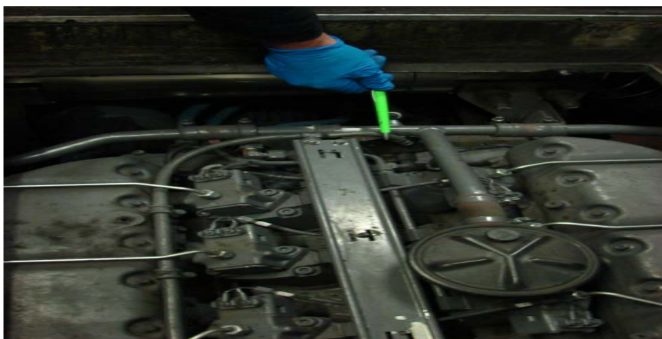
Foto 4: Brændstofslange uden brandskade
