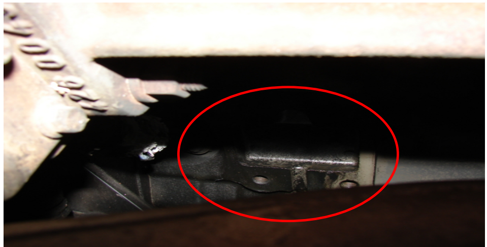
Foto 7: Spor af lækage af dieselolie på motorblok
