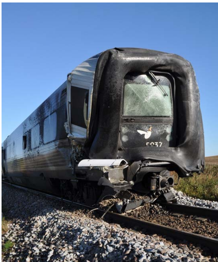
Foto 3 Skader på fronten af MF 5037
