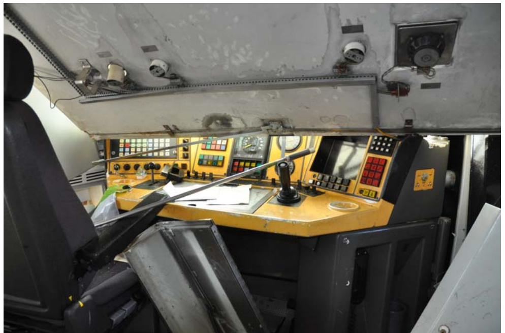
Foto 14 Skader i førerrummet MF 5037
