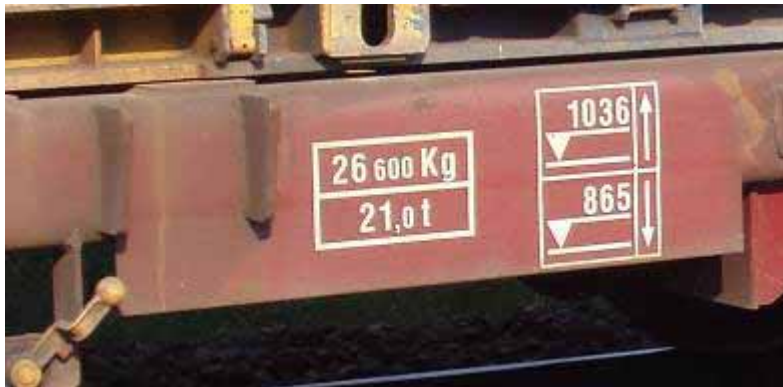
Abbildung 60 Fehlende rote Umrandung der Anschrift der bodenbedienbaren Handbremse
