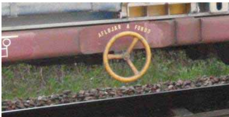
Abbildung 61 Bodenbedienbare Handbremse - Quelle ÖBB
