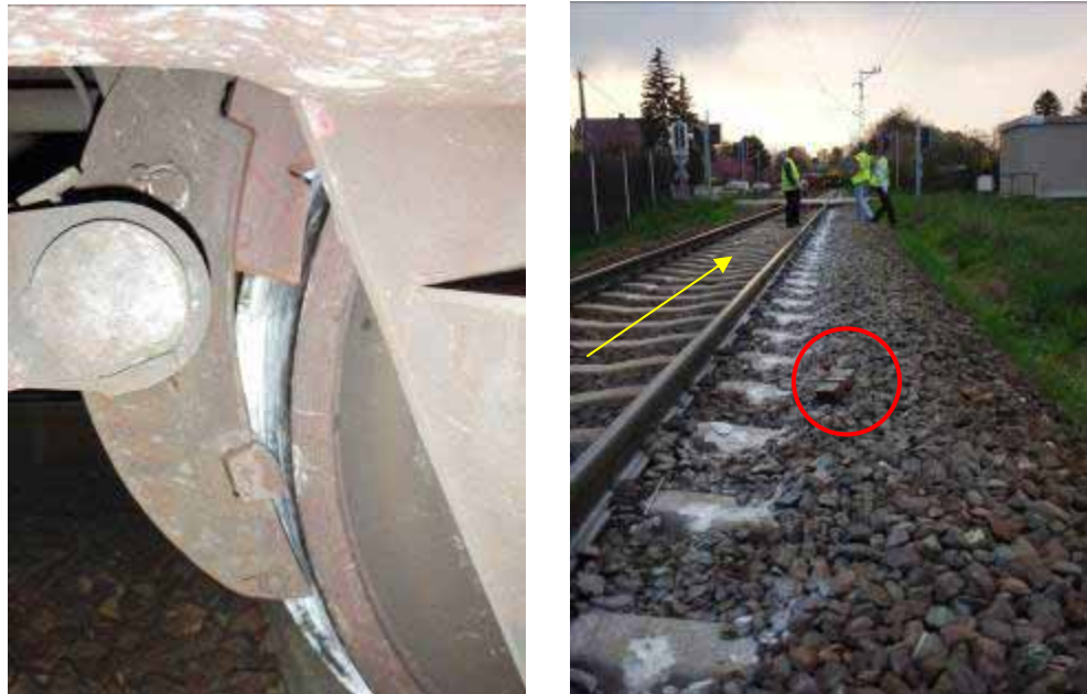
Abbildung 16 Gebrochener aufgefundener Bremsklotz
