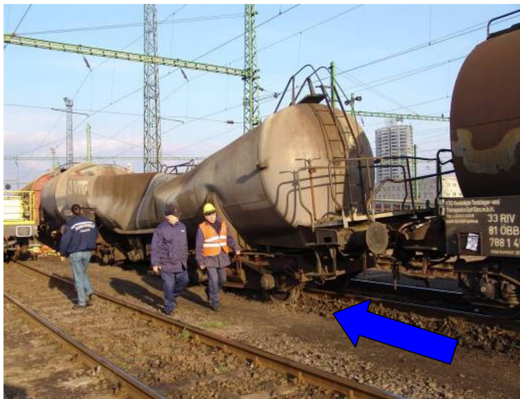
4. ábra: A 4 tengellyel siklott 33 80 787 5872-3 pályaszámú összeroppant testű tartálykocsi
