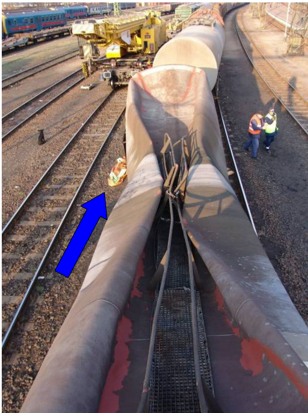
7. ábra: A 33 80 787 5872-3 pályaszámú kocsi összeroppant tartályteste
