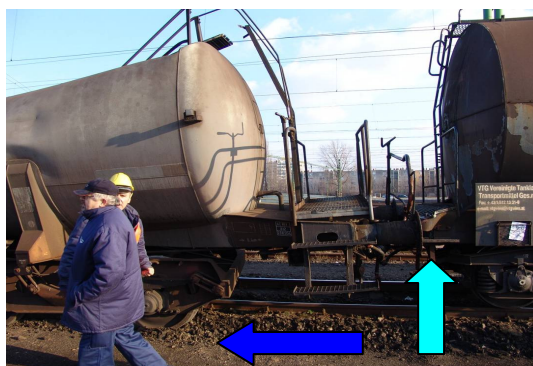
4. ábra: A 4 tengellyel siklott 33 80 787 5872-3 pályaszámú összeroppant testű tartálykocsi
