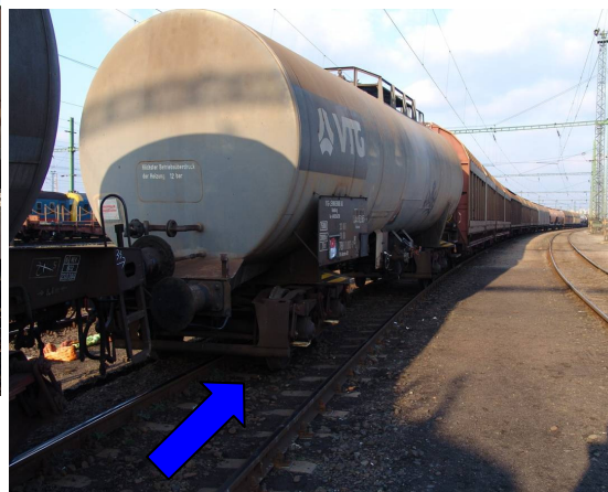
5. - 6. ábra: 33 81 788 1450-9 pályaszámú tartálykocsi menetirány szerinti bal első ütköző tányérja leszakadt és a kocsi fékállása megsérült
