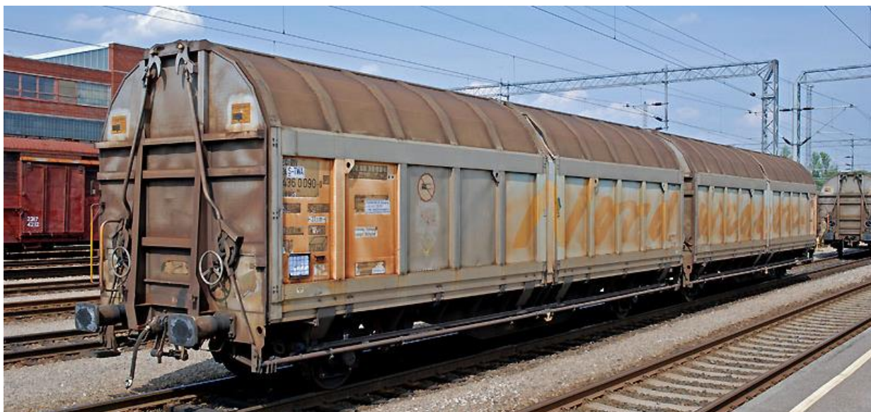
Slika 4: Tretji primer enote, sestavljene iz kompozicije trajno povezanih elementov, ki ne morejo obratovati ločeno (samopraznilni vlak).
