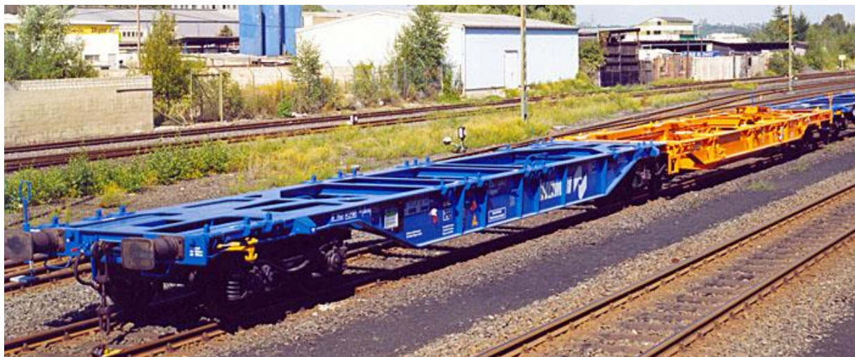
Slika 2: Prvi primer enote, sestavljene iz kompozicije dveh trajno povezanih elementov (modrega in oranžnega), ki ne moreta obratovati ločeno (členkast vagon).
