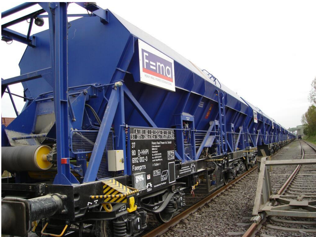
Slika 4: Tretji primer enote, sestavljene iz kompozicije trajno povezanih elementov, ki ne morejo obratovati ločeno (samopraznilni vlak).
