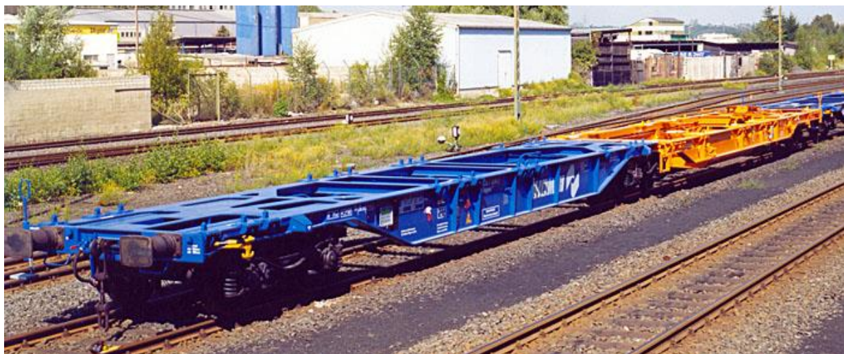
Figura 2: Exemplul 1 de unitate alcătuită dintr-o garnitură de două elemente conectate permanent (albastru și portocaliu), care nu pot fi operate separat (vagon articulată)
