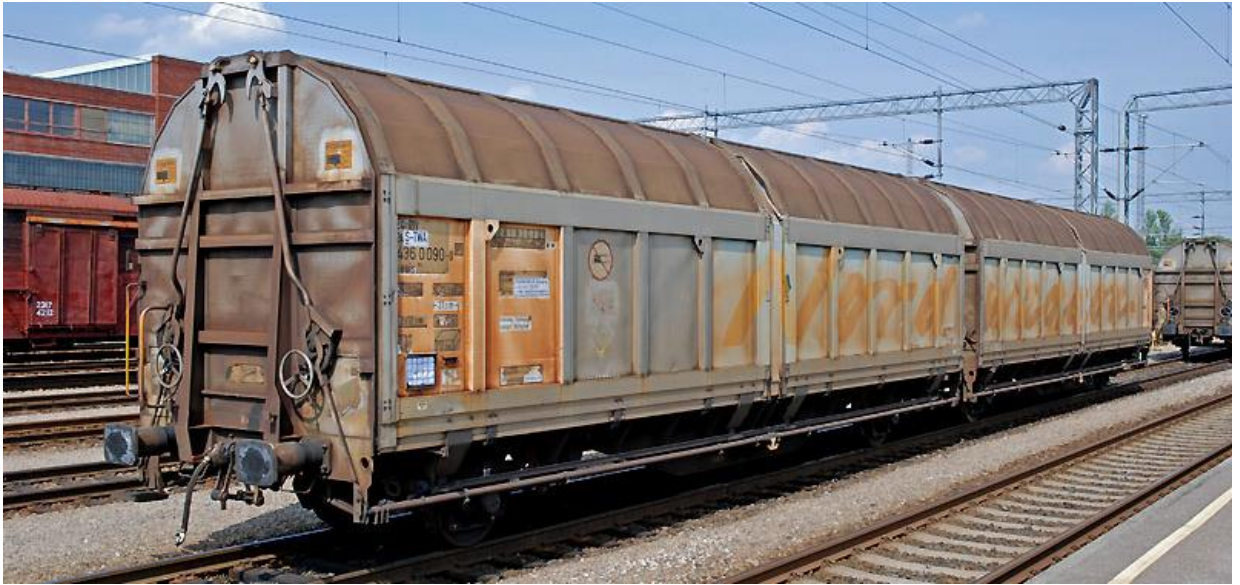
Figura 4: Exemplul 3 de unitate alcătuită dintr-o garnitură de elemente conectate permanent care nu pot fi exploatare separat (tren cu auto-descărcare)
