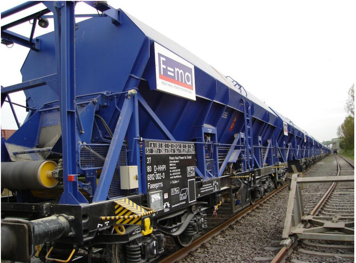
Figura 4: Exemplul 3 de unitate alcătuită dintr-o garnitură de elemente conectate permanent care nu pot fi exploatare separat (tren cu auto-descărcare)
