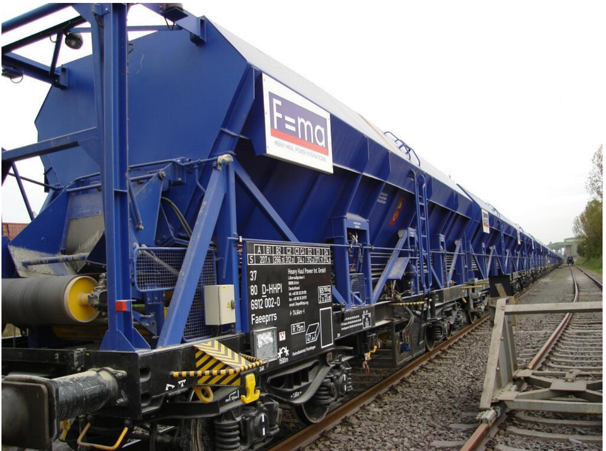
Figuur 4: Voorbeeld 3 van een eenheid bestaande uit een samenstel van permanent aan elkaar gekoppelde elementen die niet afzonderlijk van elkaar kunnen functioneren (zelfontladende trein)
