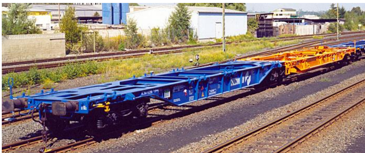
Figure 2: Exemple 1 d'unité composée d'une rame de deux éléments reliés de manière permanente (un bleu et un orange) et ne pouvant pas être exploités séparément (wagon articulé)
