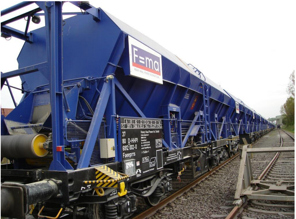
Figure 4: Exemple 3 d'unité composée d'une rame d'éléments reliés de manière permanente et ne pouvant pas être exploités séparément (train à déchargement automatique)
