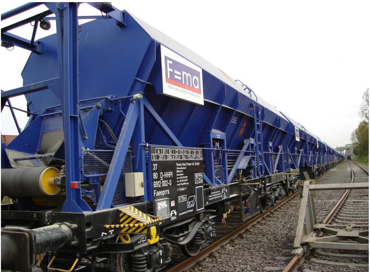
Σχήμα 4: Παράδειγμα 3 μονάδας που συνίσταται σε συρμό αποτελούμενο από μόνιμα συνδεδεμένα στοιχεία, τα οποία δεν είναι δυνατόν να λειτουργούν χωριστά (συρμός αυτόματης εκφόρτωσης)
