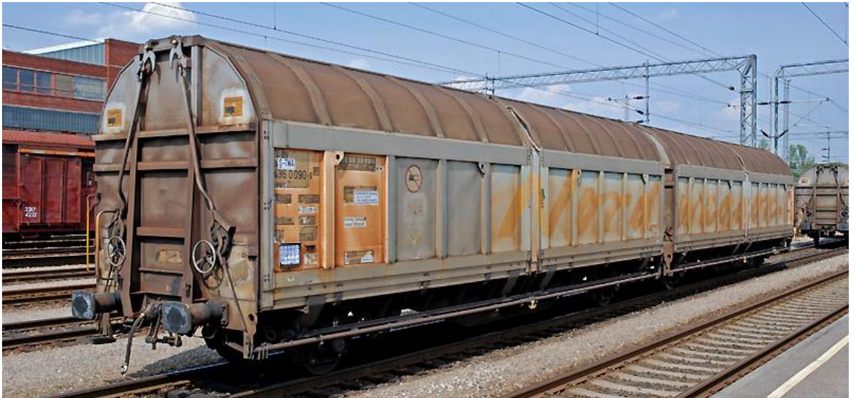
Σχήμα 4: Παράδειγμα 3 μονάδας που συνίσταται σε συρμό αποτελούμενο από μόνιμα συνδεδεμένα στοιχεία, τα οποία δεν είναι δυνατόν να λειτουργούν χωριστά (συρμός αυτόματης εκφόρτωσης)
