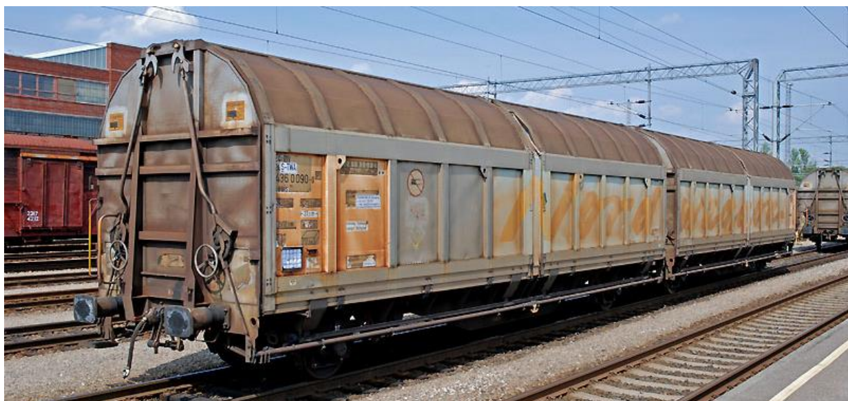
Obrázek 4: Příklad 3 jednotky, kterou tvoří souprava trvale spojených prvků, přičemž uvedené prvky nelze provozovat samostatně (samovysypné vozy).
