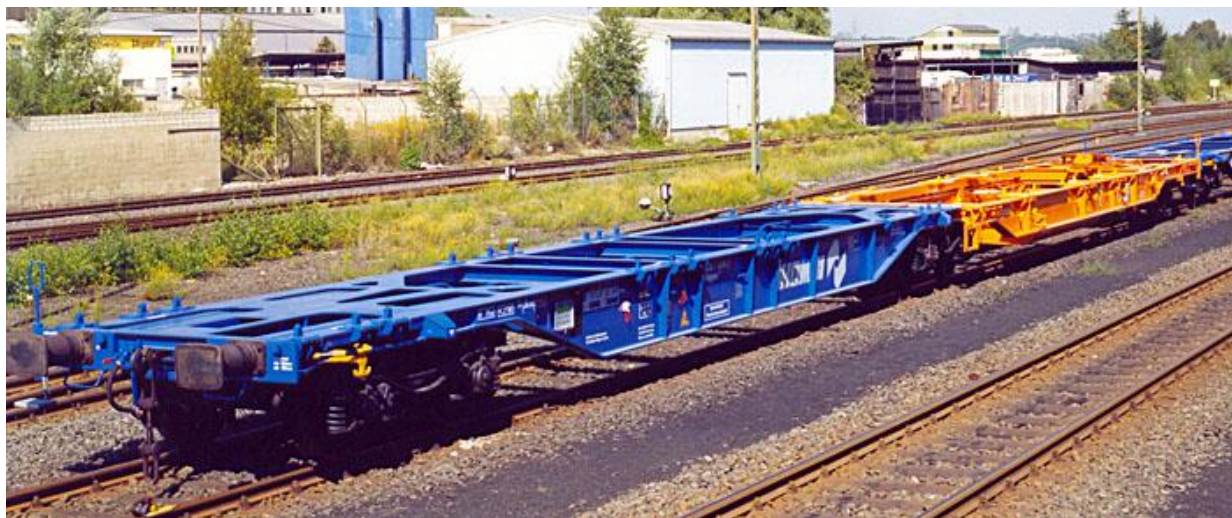
Obrázek 2: Příklad 1 jednotky, kterou tvoří souprava trvale spojených dvou prvků (modrého a oranžového), přičemž uvedené prvky nelze provozovat samostatně (členěný vůz).
