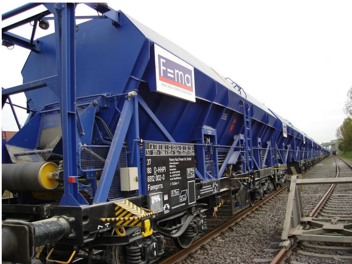
Obrázek 4: Příklad 3 jednotky, kterou tvoří souprava trvale spojených prvků, přičemž uvedené prvky nelze provozovat samostatně (samovysypné vozy).
