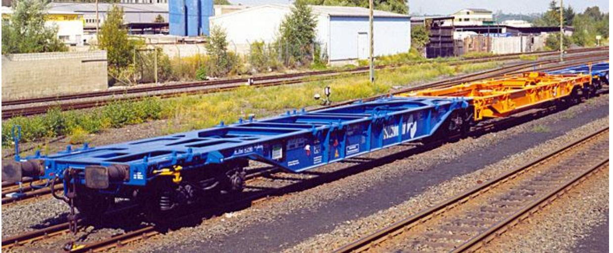
Фигура 3: Пример 2 за единица, състояща се от група от два постоянно свързани елемента, които не могат да бъдат експлоатирани поотделно
