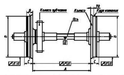
А — расстояние между внутренними торцами (граними) ободьев колес; В — ширина обода колеса; С — расстояние между упорным торцем предподступичной части оси и внутренним торцем обода колеса; В — диаметр колес по кругу катания; Е — допуск радиального биения круга катания колеса; F — допуск торцевого биения внутреннего торца обода колеса; G — геомстрическая ось колесной пары
