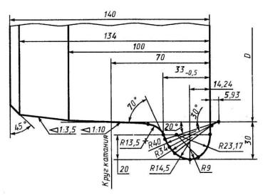
Рисунок 3 — Профиль обода колеса для локомотивов
