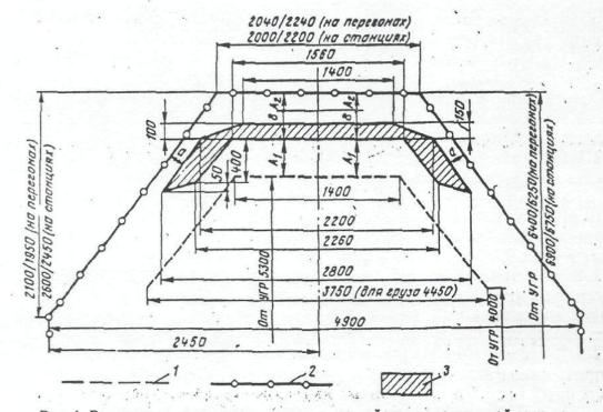
Рис. 1. Расстояние между сооружениями, устройствами контактной сети, токоприемниками и подвижным составом:
