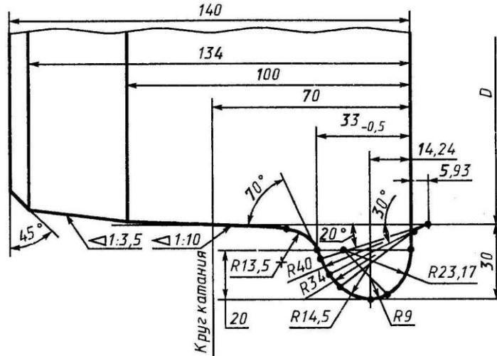
Рисунок 3 — Профиль обода колеса для локомотивов
