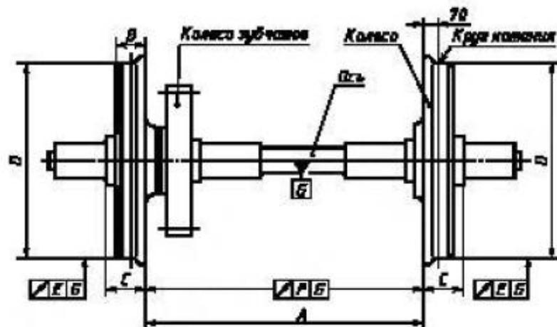
*A* – расстояние между внутренними торцами (гранями) ободьев колес; *B* – ширина обода колеса; *C* – расстояние между упорным торцом предподступичной части оси и внутренним торцом обода колеса; *D* – диаметр колес по кругу катания; *E* – допуск радиального биения круга катания колеса; *F* – допуск торцевого биения внутреннего торца обода колеса; *G* – геометрическая ось колесной пары
