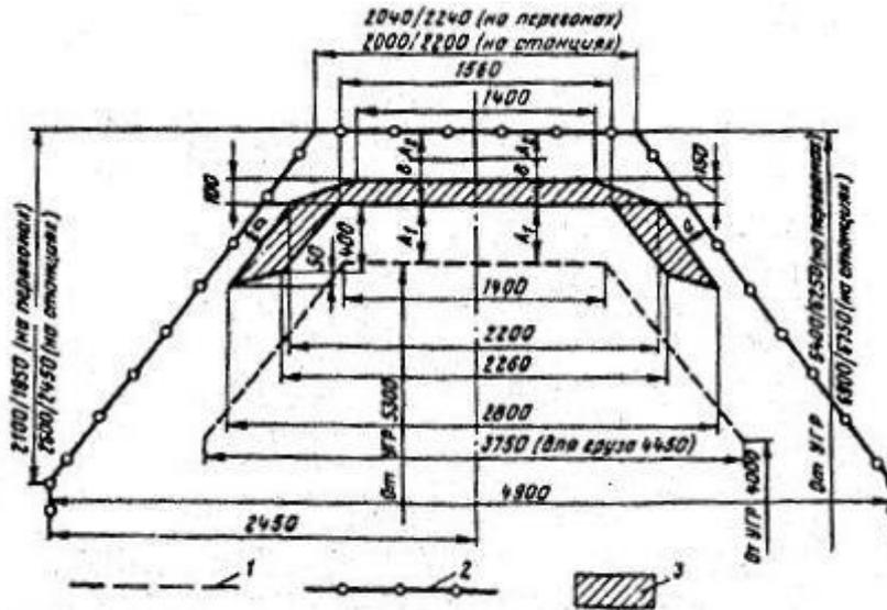
Рис. 1. Расстояние между сооружениями, устройствами контактной сети, токоприемниками и подвижным составом:
