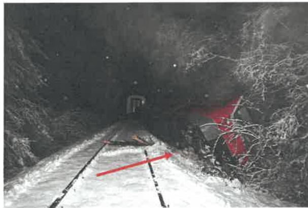
Slika: Rdeča puščica prikazuje vejo ki se je zagozdila pod prvi podstavni voziček iztirjene krmilne enote 715-126, ki je bila vzrok za iztiranje.
