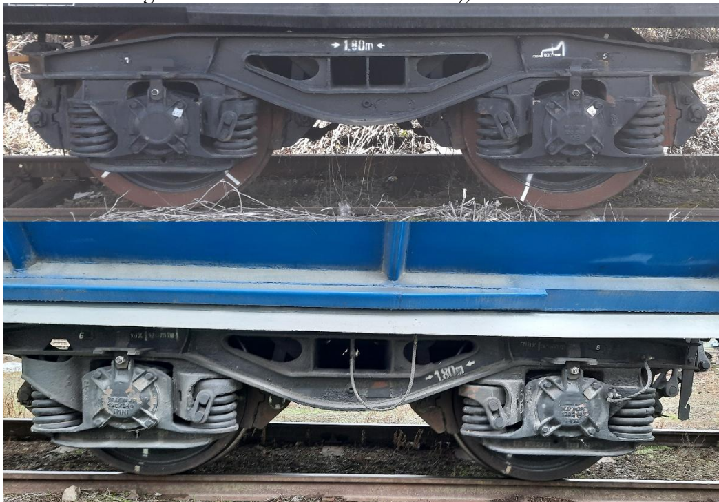
Foto comparativ privind accesul la pietrele de frecare vagon seria Fals (sus) și vagon seria Fals cu prelungire a pantei fixe(jos)
