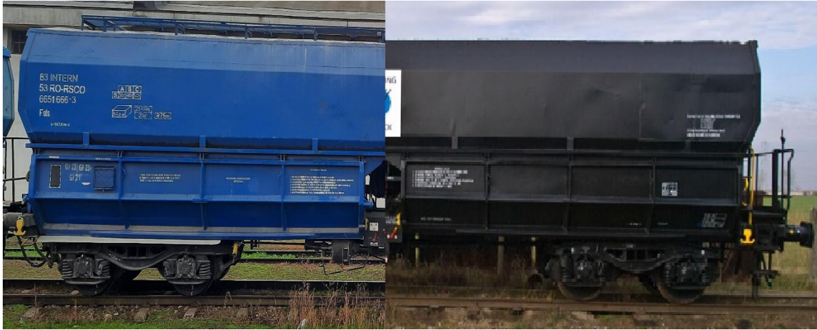
Vagon seria Fals având prelungirea pantei fixe comparat cu vagon seria Fals fără această prelungire
