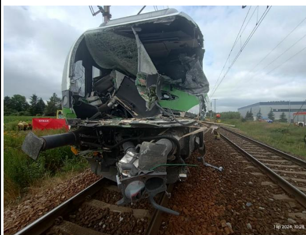
Zdjęcie 11 – Skutki zdarzenia – widok zniszczonej kabiny maszynisty pojazdu kolejowego ER75-001 (źródło: materiał przekazany przez KM)
