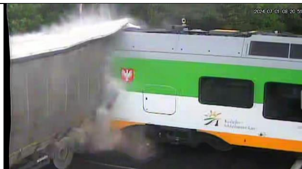
Zdjęcie 10 – Widok uderzenia pociągu osobowego KM w naczepę samochodu ciężarowego (źródło: materiał przekazany przez PKP PLK S.A.)
