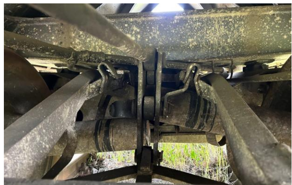
Zdjęcie 7 - Skutki zdarzenia - widok złamanej osi (źródło: materiał własny PKBWK)
