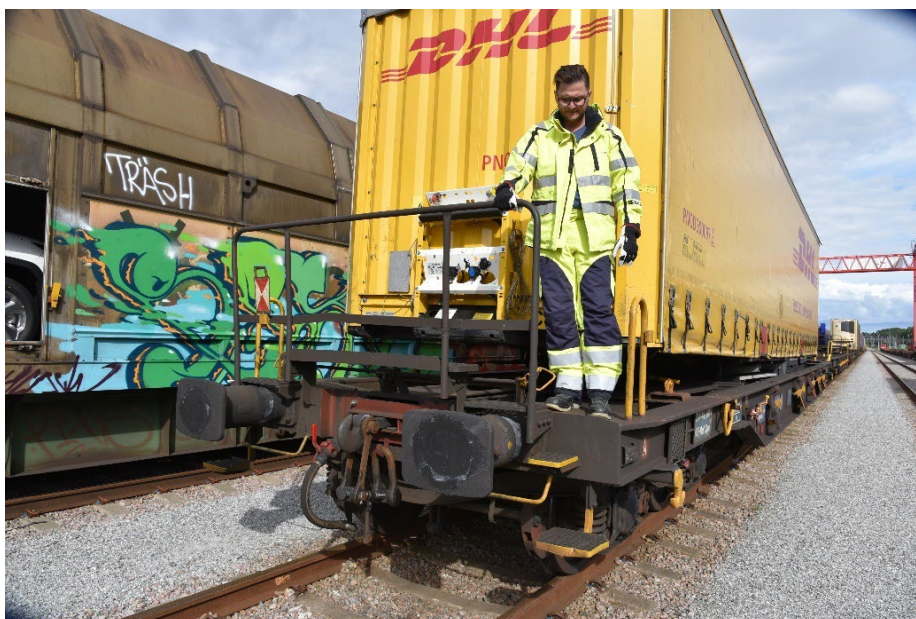
Bild från SHK:s besök i Rosersberg med en person placerad till höger om räcket varifrån signalgivaren sannolikt föll från vagnen. Notera att personen på bilden är 20 kortare än signalgivaren.
