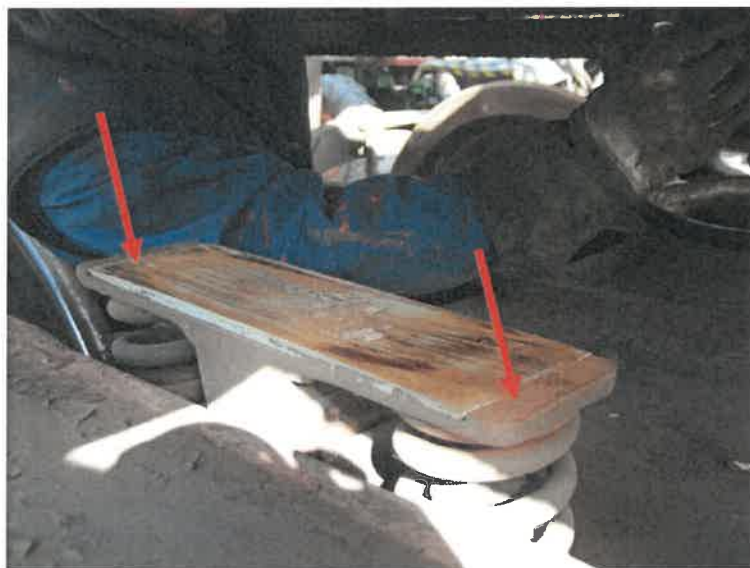
Slika: Rdeči puščici prikazujeta področje drsenja kovinskega dela drsalke po vzdolžnem nosilcu vagona zaradi obrabljenе obloge bočnih drsalk na iztirjenem podstavnem vozičku.
