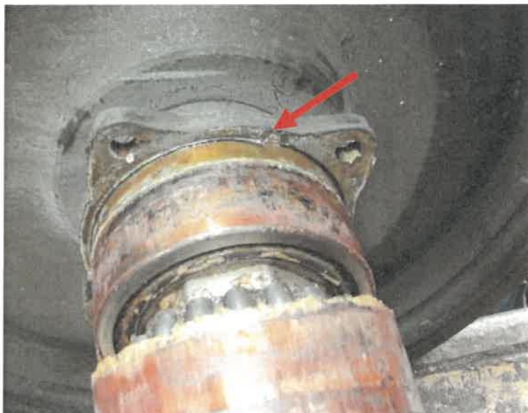
Slika: Rdeča puščica na fotografiji prikazuje strgano tesnilo ohišja enega od preostalih osnih ležajev.
