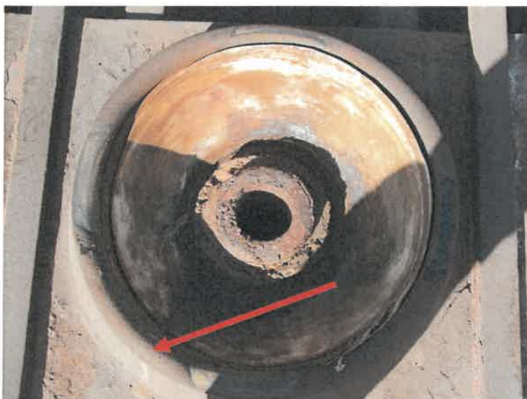
Slika: Rdeča puščica prikazuje izrabljen Ralko vložek kraljevega čepa na iztirjenem podstavnem vozičku
