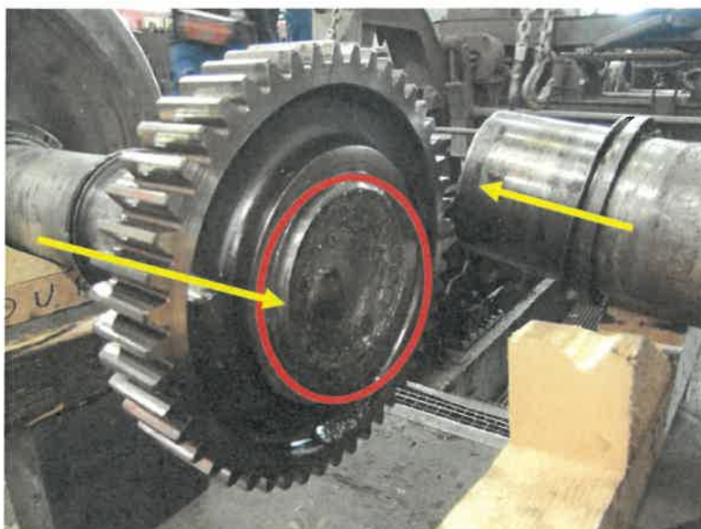
Slika: Rdeč romb označuje mesto zloma osi neposredno ob pogonskem zobniku na katerega se vpne pogonski prenos - kardan, rumeni puščici pa ponazarjata levo in desno stran osi.
