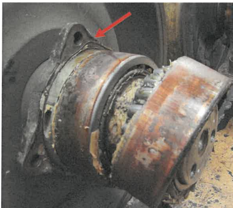
Slika: Rdeča puščica na fotografiji prikazuje deformirano tesnilo ohišja desnega ležaja na osi kjer je zaribal levi ležaj.
