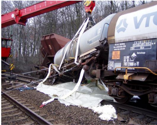
Güterzug 51245 fuhr auf den vor dem Halt zeigenden Einfahrsignal des Bahnhofs Köln Kalk Nord stehenden Güterzug 50216 auf. Darauf hin sind 11 Wagen aus Zug 51245 entgleist und zum Teil in Schräglage geraten.
