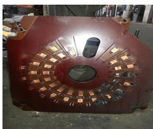
Снимки на локомотив № 44-169.1 и неговия 33-позиционен дисков избирач на степените след пожара в локомотива, възникнал на 13.10.2015 г. в междугарието Елин Пелин - Вакарел
