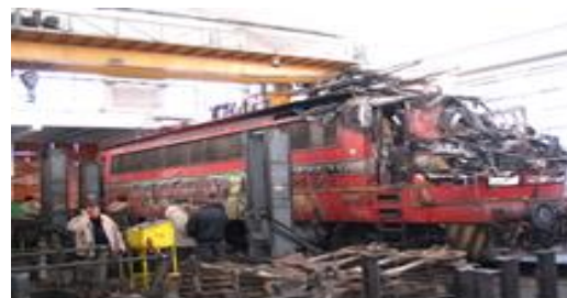
Локомотив № 42081.0 на БДЖ-ПП ЕООД след пожара в гара Шумен на 19.12.2012 г.
