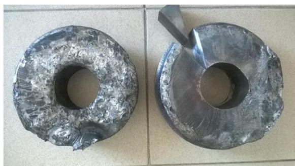
Фигура 6 – подбитости получени при движение от момента на скъсване на оста до момента на спиране на локомотива
