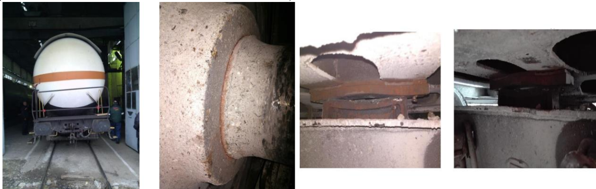
Фигура 5 – при изглед на вагона чело откъм буферите стоящ на прав хоризонтален коловоз видимо се забелязва, че кошът и рамата на вагона стоят наклонени на една страна (в случая наляво). Впоследствие е установено, че това е страната, от която се намира и разпресованото колело при първа букса на първа колоос. От извършения подробен оглед на ходовата част на вагона е установено, че плъзгалките (опорите, чрез които кошът и рамата на вагона лягат върху рамата на талигата) от страната на разпресованото колело са силно износени и подбити както на първата талига, така и на втора талига.
