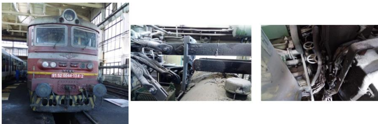
Фигура 7 – стопенит материал на медните шини прокапва върху кабелите намиращи се под шините, разтопява тяхната изолация, което води до запалване и предизвиква пожар в машинното отделение.
