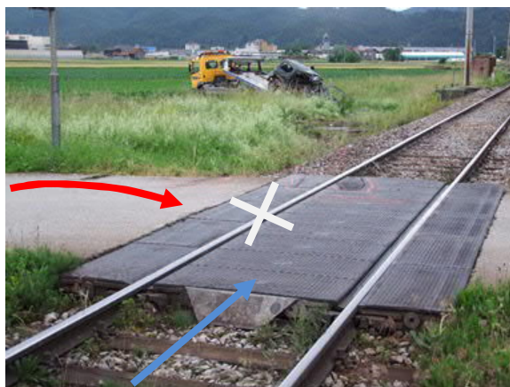
Slika 4: Rdeča puščica označuje smer vožnje cestnega osebnega motornega vozila ter mesto kjer je voznik z vozilom zapeljal v območje nivojskega prehoda mimo spuščene polzapornice, modra tir in smer mednarodnega tovornega vlaka, bel križ pa točko trčenja
