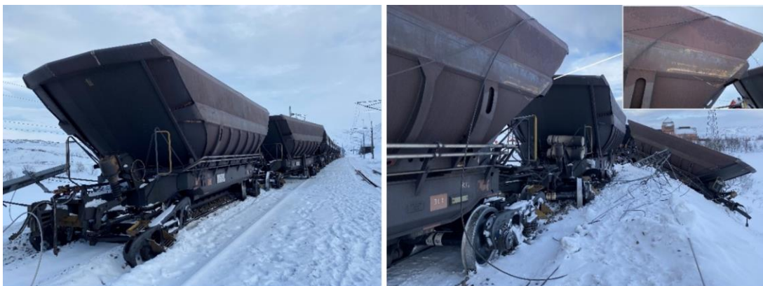
Figur 12 visar till vänster vagn tio och nio framåt i tågets färdriktning. Till höger visas vänster sida av vagn nio, med skrapmärken och vidare vagn tio samt vagn 14 nere i slänten.
