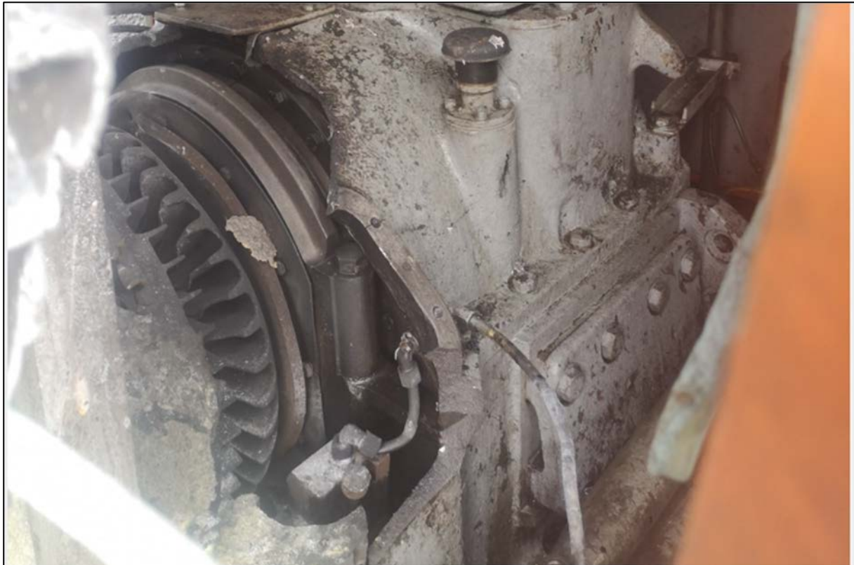
Abbildung 19: Zerstörtes Voith-Getriebe L37 AB
