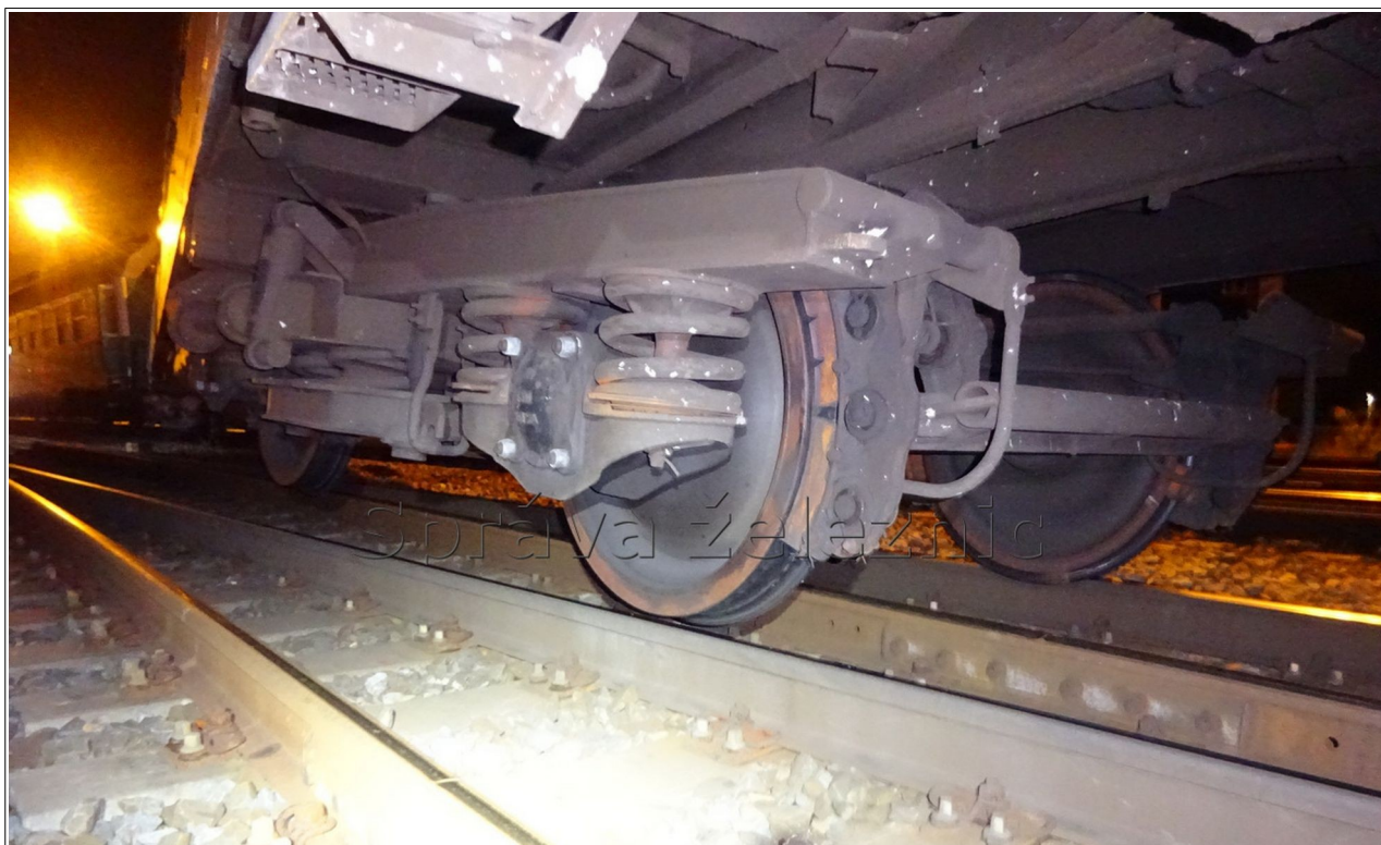
Obr. č. 8: Přední vykolejený podvozek ve směru jízdy posunového dílu (podvozek „b“) VDV 063.420-4 stojící v konečném postavení po MU na výhybce č. 7
