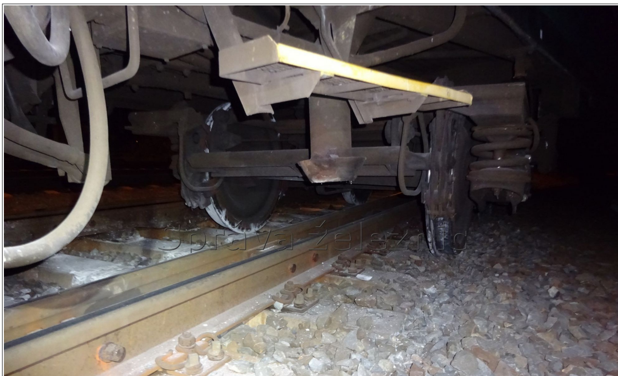
Obr. č. 9: Zadní vykolejený podvozek ve směru jízdy posunového dílu (podvozek „a“) VDV 063.420-4 stojící v konečném postavení po MU na výhybce č. 10
