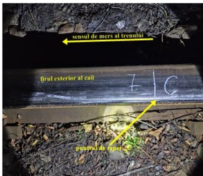
Foto nr.4: Punctul „C” – urma de escaladare a roții din partea dreaptă a osiei nr.2, în sensul de mers
