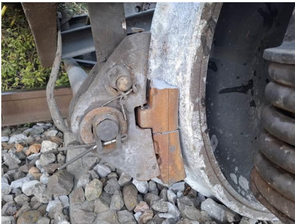
Foto nr.1 - sabotul de frână al roții R7(exterior) spart nou (100%)
