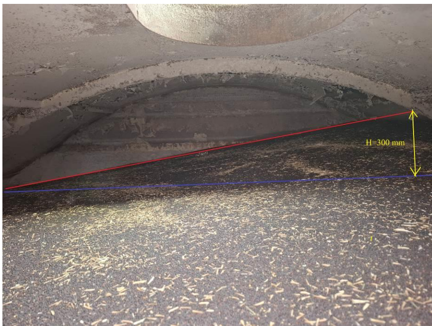
Foto nr.5 - încărcătura repartizată neuniform pe colțul cutiei vagonului din partea dreaptă a sensului de mers (pe partea dreaptă a boghiului deraiat), unde diferența de înălțime față de colțul din stânga este cu aproximativ 300 mm mai mare.
